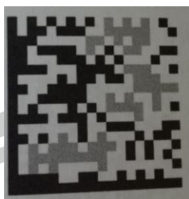
ภาพประกอบ 3.25 โค้ดดำด้าเมทริกซ์ที่มีการแปรผันของค่าการสะท้อนแสงพื้นผิว [19]
