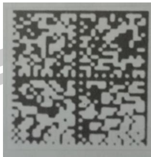
ภาพประกอบ 3.28 ตัวอย่างภาพโค้ดที่มีค่าความเสียหายที่เกิดกับแพตเทิร์นคงที่ซึ่งถูกพิจารณาเป็นเกรด F และมีเกรด Modulation เป็นเกรด C [19]
