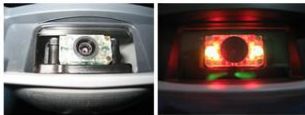
ภาพประกอบ 2.19 Image scanner มีกล้องอยู่ตรงกลาง [15]
