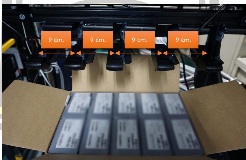
ภาพประกอบ 3.5 ระยะห่างระหว่าง HD Pro Webcam C920 แต่ละตัว (ภาพนี้มีการปรับแต่งเบลอนี้เนื่องจากเป็นความลับทางการค้า)
