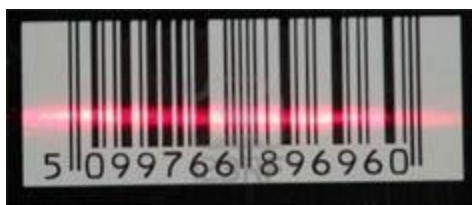
ภาพประกอบ 2.18 Laser scanner จะมีเส้นสแกนเป็นแสงเลเซอร์ [15]
