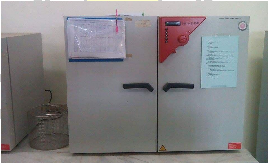
ภาพภาคผนวกที่ 10 ตู้อบลมร้อน (Hot air oven) ใช้สำหรับอบตัวอย่างไล่ความชื้น
