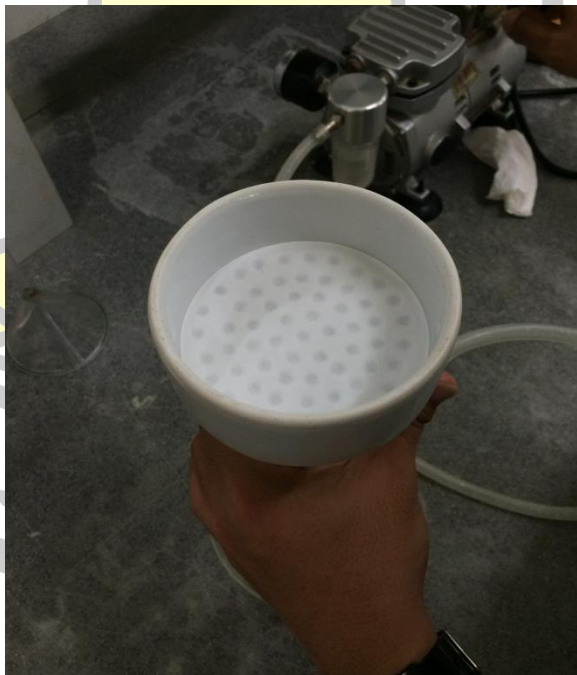
ภาพภาคผนวกที่ 8 ลักษณะการล้างทำความสะอาดผ่านการกรองผ่านด้วยระบบสุญญากาศ
