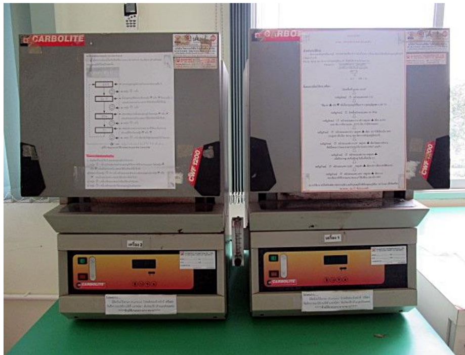
ภาพภาคผนวกที่ 13 เตาเผาที่ใช้สำหรับเผาเปลือกไข่ และแคลเซียมคาร์บอเนตให้ได้เป็นแคลเซียมออกไซด์
