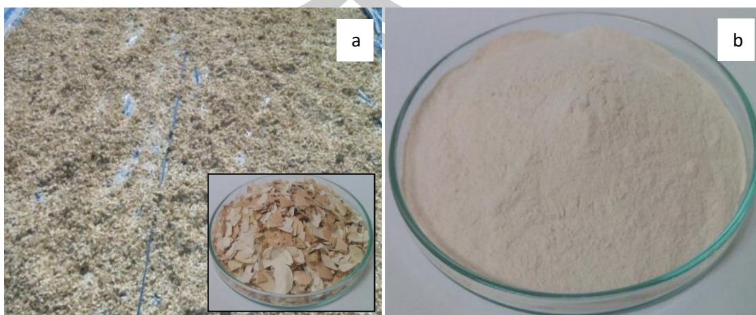
ภาพประกอบที่ 29 a) เปลือกไข่ไก่ที่ผ่านการล้างและทำความสะอาด b) ผงเปลือกไข่ ขนาดไม่เกิน 125 ไมโครเมตร
