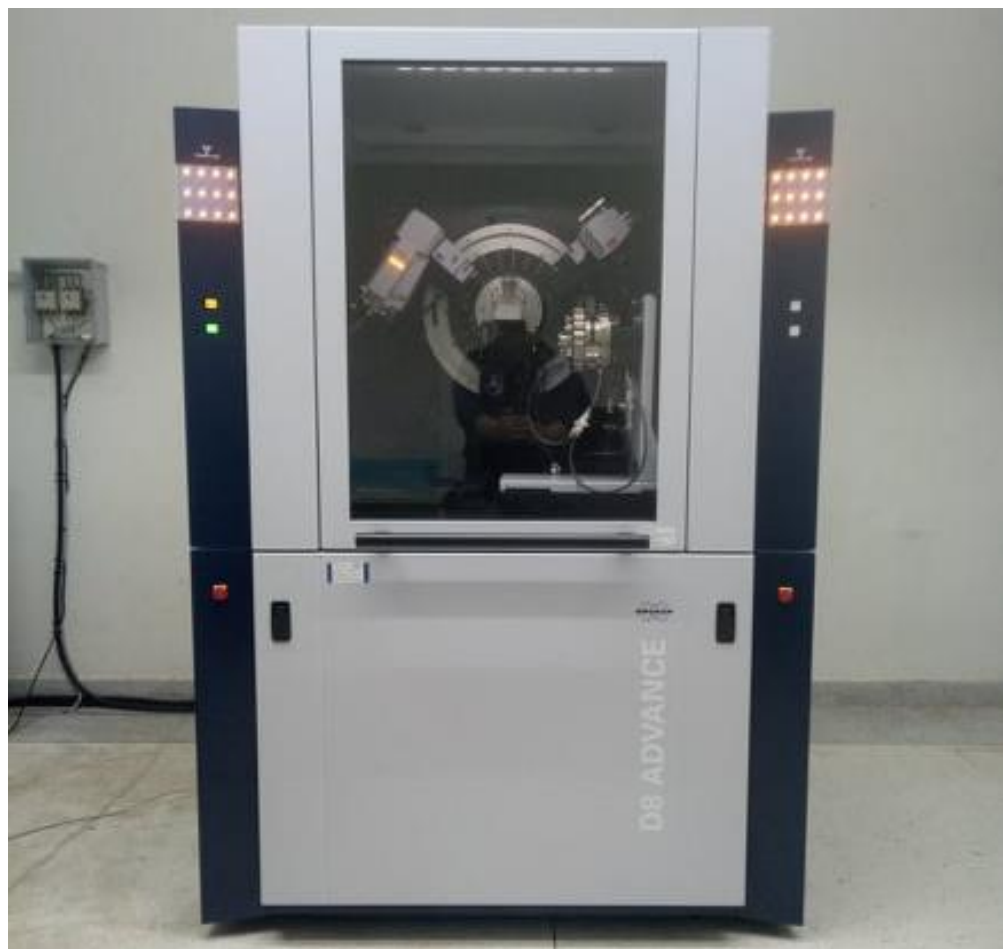
ภาพภาคผนวกที่ 17 เครื่องวิเคราะห์ X-ray Diffractometer (XRD)
