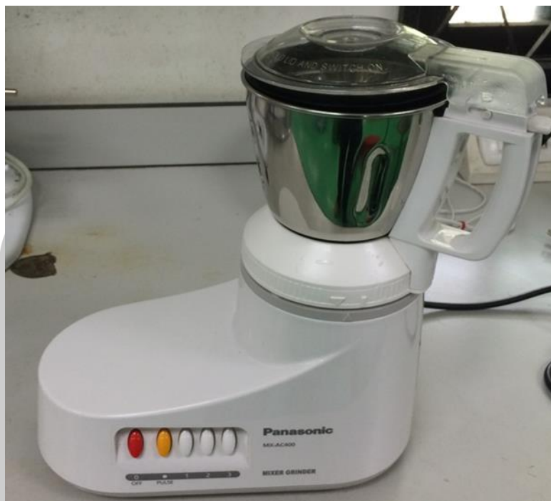
ภาพภาคผนวกที่ 3 เครื่องปั่นความเร็วรอบสูงใช้ในการหอร์โมนีเจียสเปลือกไข่ให้ละเอียด
