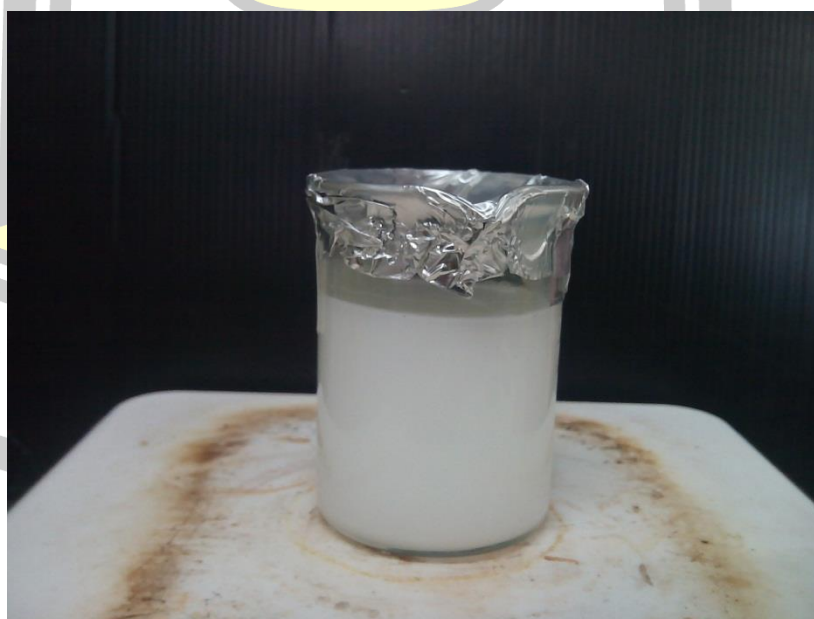
ภาพภาคผนวกที่ 6 หลังจากการทำปฏิกิริยาระหว่างสารละลายแคลเซียมคลอไรด์กับสารละลายโซเดียมคาร์บอเนต จะได้ตะกอนแคลเซียมคาร์บอเนตแขวนลอยอยู่ในสารละลาย มีลักษณะสีขาวขุ่น
