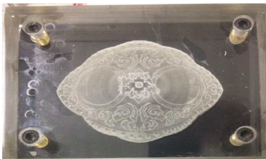
(ข) ต้นแบบแม่พิมพ์ปั๊มชิ้นงานห่วงรัดขึ้น ที่สมบูรณ์ ภาพประกอบ 4.25 ต้นแบบแม่พิมพ์ปั๊มชิ้นรูป (Die) ชิ้นงานห่วงรัดขึ้น
