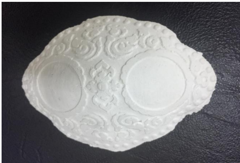
(ข) ปูนปลาสเตอร์ที่ได้จากการเทลงบนแม่พิมพ์ยางพารา ภาพประกอบ 4.39 แม่พิมพ์ยางพารา และปูนปลาสเตอร์ต้นแบบแม่พิมพ์ หล่อชิ้นงานห่อรังผึ้ง
