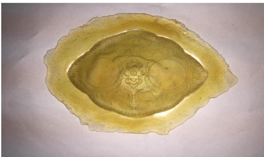
ภาพประกอบ 4.26 แม่พิมพ์ยางพารา และลวดลายที่ได้จากการทดสอบ
