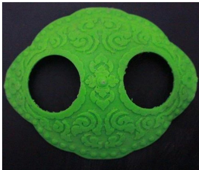
ภาพประกอบ 3.6 ต้นแบบชิ้นงานที่ได้จากเครื่องปริ้น 3 มิติ (ชนากร สีทะนารัตน์ และ อีรวุฒิ กิตติวงศ์โสภณ : 2560)
