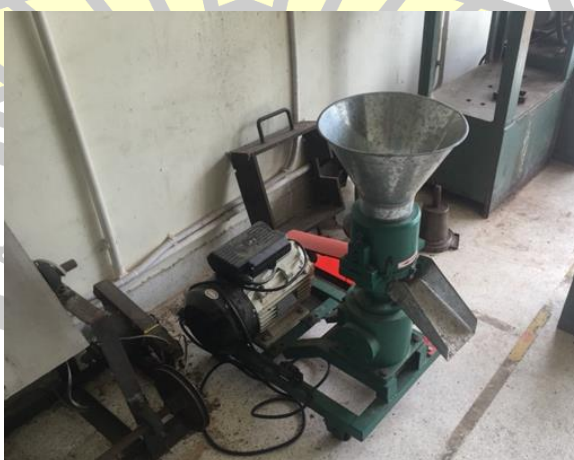
ภาพประกอบ 28 เทคโนโลยีการอัดขึ้นรูปเชื้อเพลิง Pellet
