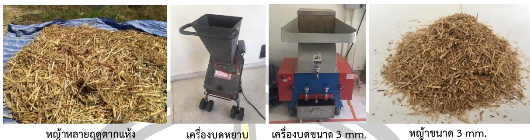
ภาพประกอบ 24 ขั้นตอนการเตรียมตัวอย่างหญ้าขนาด 3 มิลลิเมตร
