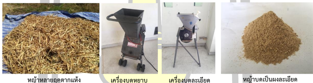
ภาพประกอบ 25 ขั้นตอนการเตรียมตัวอย่างหญ้าขนาดบดผงละเอียด
