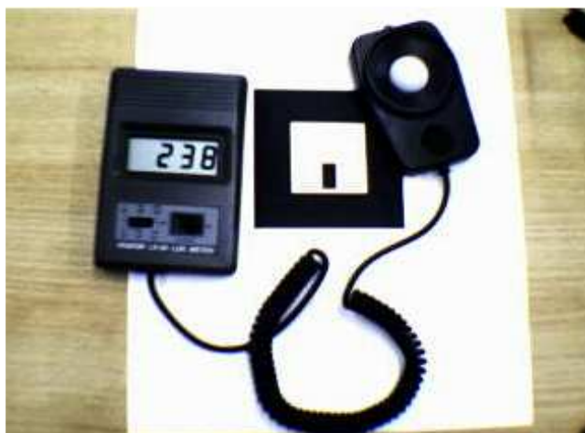
รูปที่ 6 การทดลองปรับความส่องสว่าง
