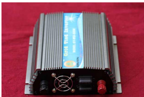
ภาพประกอบ จ.18 เครื่องแปลงกระแสไฟฟ้าแบบ Grid-Tie Inverter ขนาด 1000 W (พลังงานทดแทนเพื่อคนไทย, 2555 ก)
