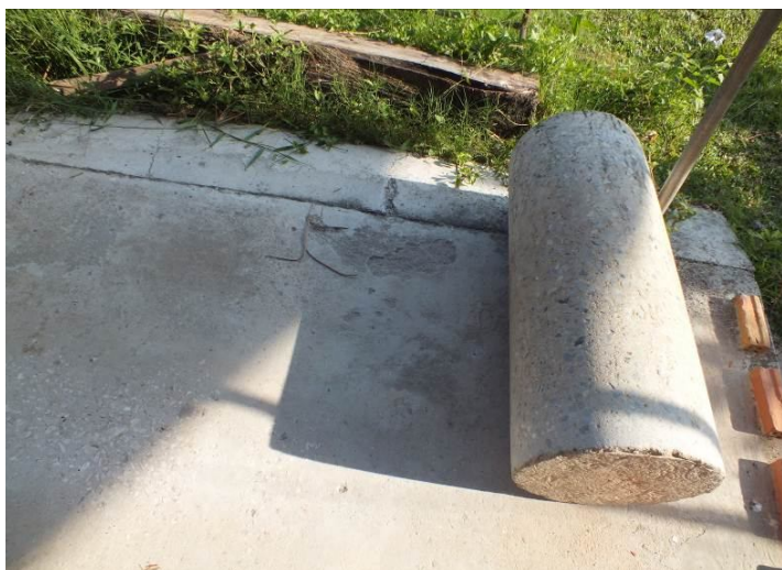
ภาพประกอบ 28 ลูกกลิ้งคอนกรีตอุปกรณ์ทำให้เส้นตอกพีชกระจัดแบนเรียบ
