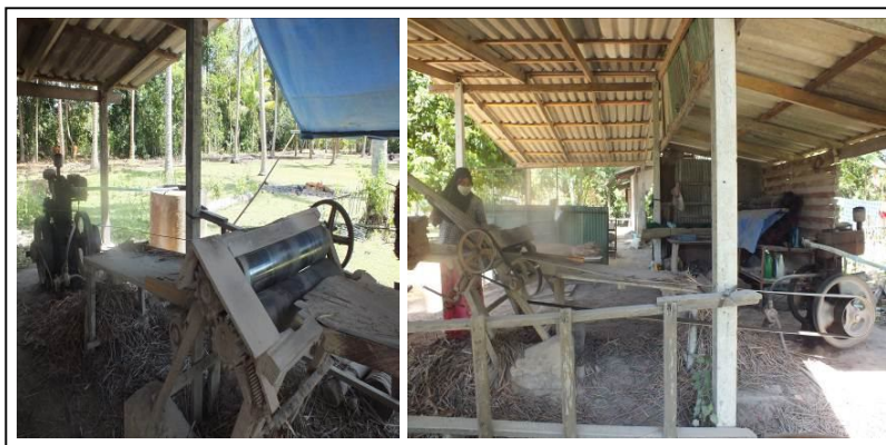
ภาพประกอบ 87 เครื่องรีดกระจูดมาตรฐานเครื่องยนต์ดีเซลในชุมชนบ้านทอน
