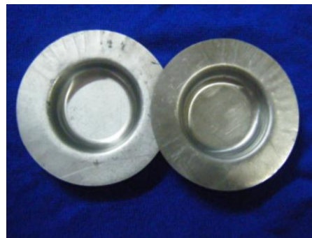
(ค11.2) ชิ้นงานที่เกิดรอยยุบ
