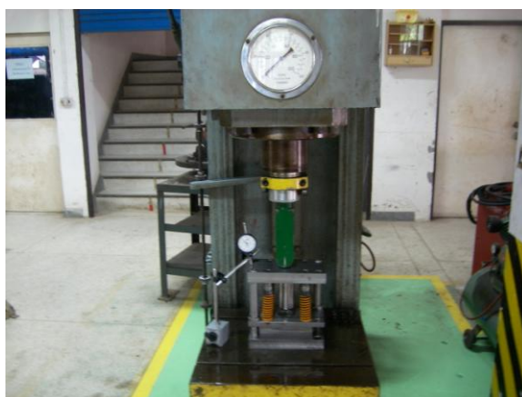
ภาพประกอบ 4.13 ขั้นตอนการลากขึ้นรูปชิ้นงาน
