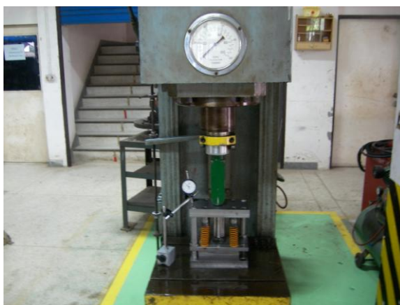
ภาพประกอบ ค 15 แม่พิมพ์พร้อมทำการลากขึ้นรูปชิ้นงานจริง
