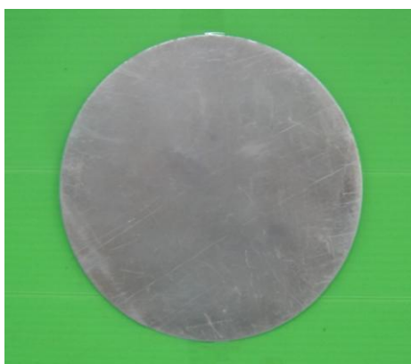
ภาพประกอบ 4.10 ลักษณะแผ่นชิ้นงานเริ่มต้นที่จะทำการขึ้นรูป
