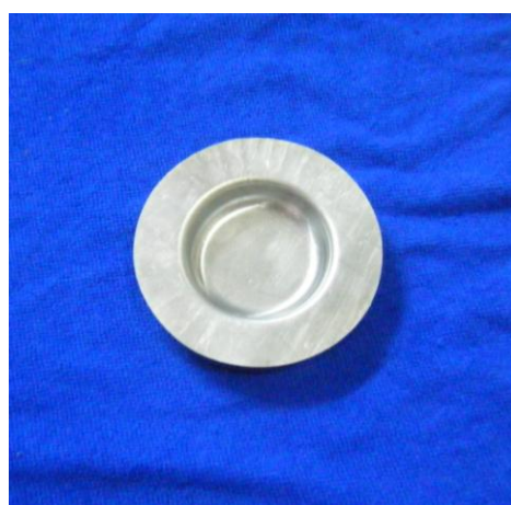
(ข) ชิ้นงานที่เกิดรอยร่วน
