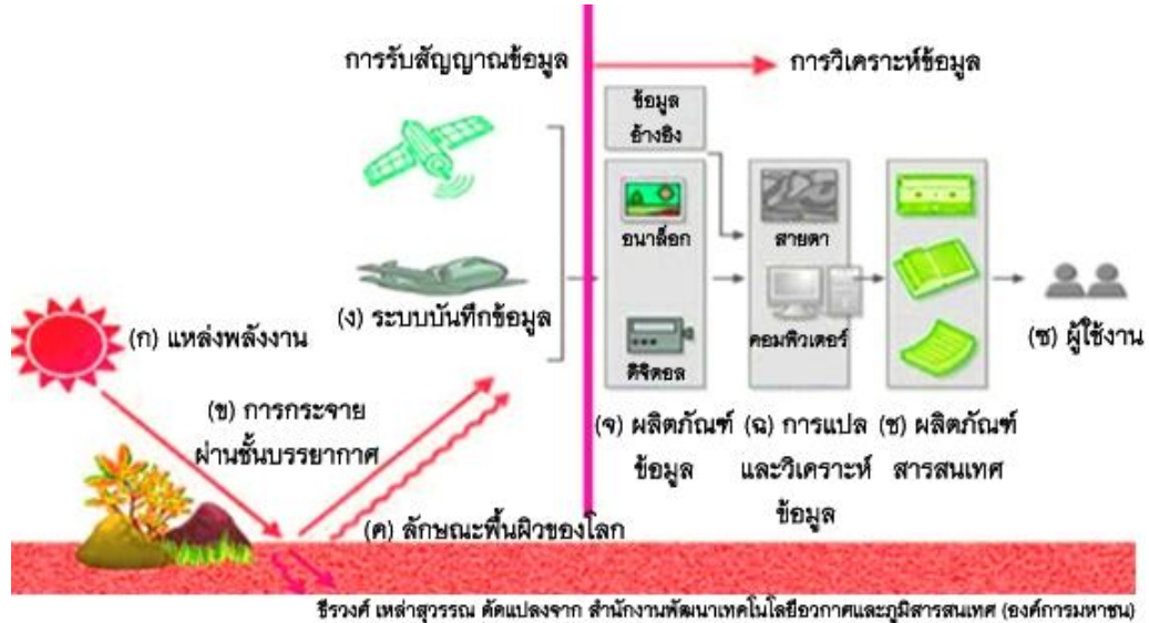
ภาพประกอบ 2.5 กระบวนการและองค์ประกอบการรับรู้จากระยะไกล
