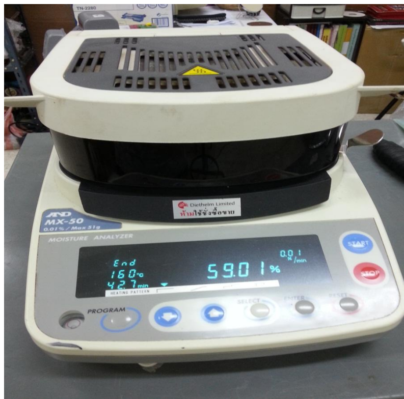
ภาพประกอบ ข.1 เครื่องชั่งน้ำหนักแบบดิจิทัลความละเอียดทศนิยม 2 ตำแหน่ง
