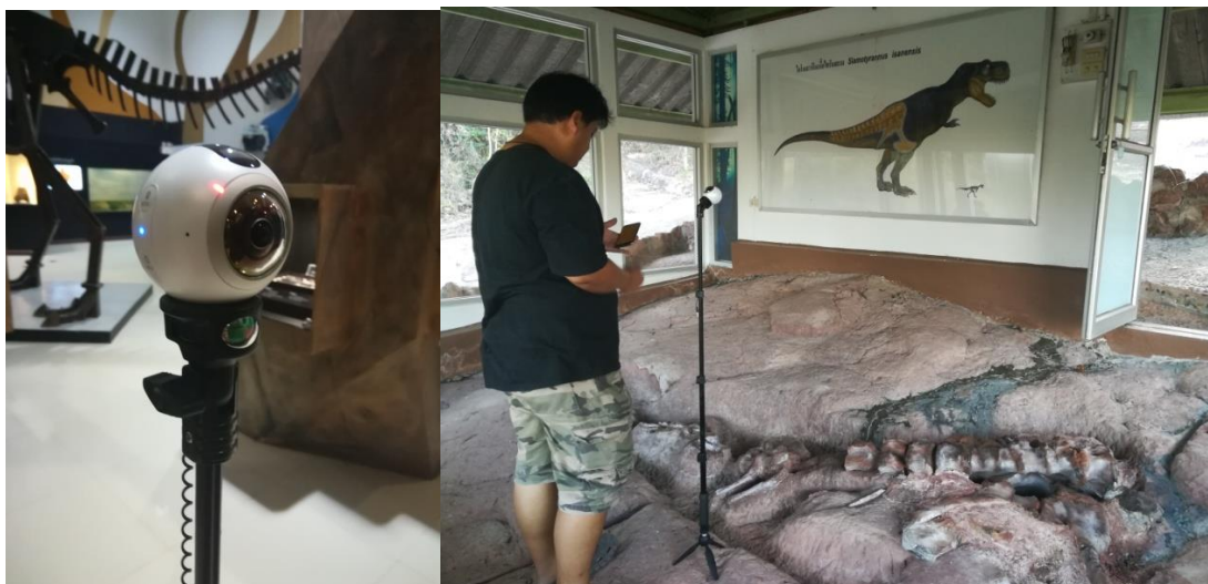
ภาพที่ 36 การลงพื้นที่เก็บภาพ โดยใช้กล้องถ่ายภาพ 360 องศา ยี่ห้อ Samsung Gear 360 พร้อมอุปกรณ์ขาตั้งกล้อง และควบคุมผ่านโทรศัพท์มือถือ
