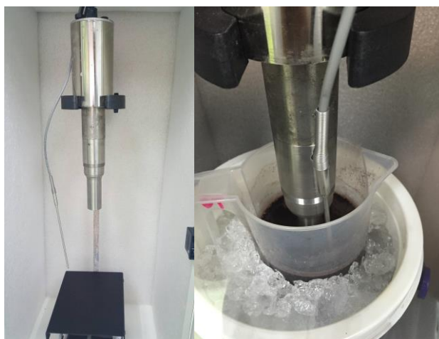
ภาพประกอบ 3.3 การสกัดสมุนไพรโดยใช้ตัวทำละลายร่วมกับคลื่นเสียงความถี่สูง ด้วยเครื่องกำเนิดคลื่นเสียงความถี่สูง (ultrasound-assisted solvent extraction, UAE)
