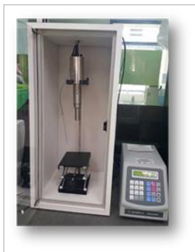
ภาพประกอบ 2.7 ลักษณะของเครื่อง ultrasound-assisted solvent extraction
