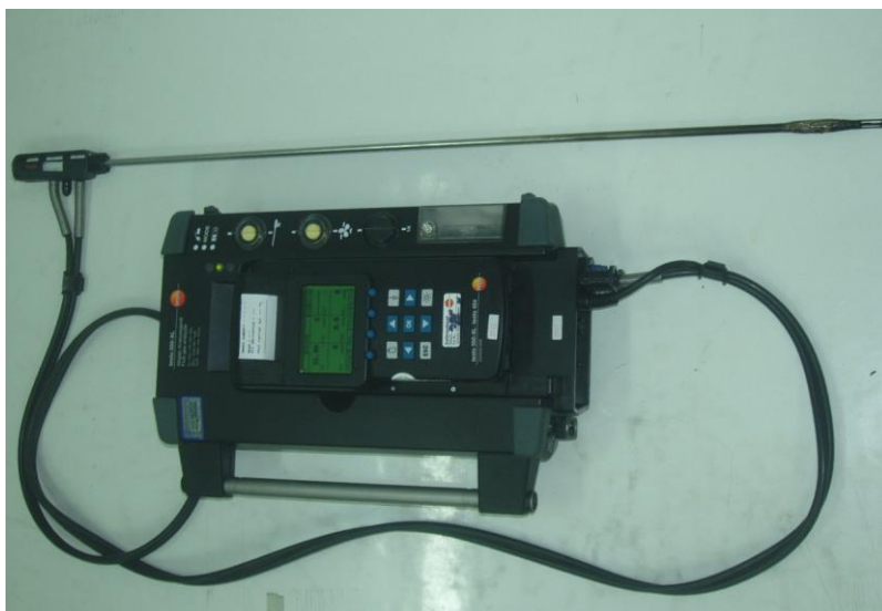
ภาพประกอบ 3.6 เครื่องวัดประสิทธิภาพการเผาไหม้ รุ่น testo 350 M/XL
