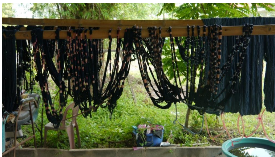
ภาพประกอบ 67 เส้นใยฝ้ายที่ย้อมสีครามแล้วตากผึ่งลมให้แห้ง
