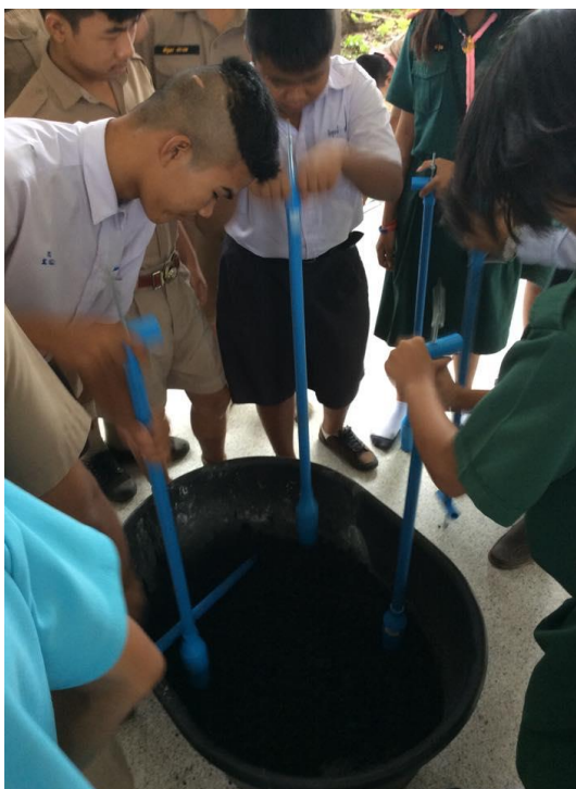
ภาพผนวกที่ 13 การทำถ่านอัดแท่งด้วยอุปกรณ์อัดถ่านอย่างง่าย
