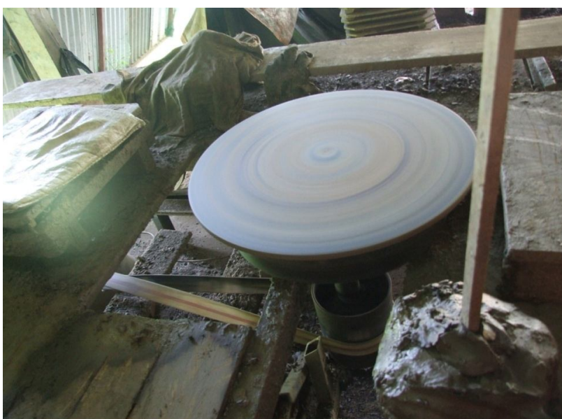
ภาพประกอบ 37 แป้นหมุน เครื่องมืออุปกรณ์การผลิต การปั้นหรือการขึ้นรูปเครื่องปั้นดินเผา
