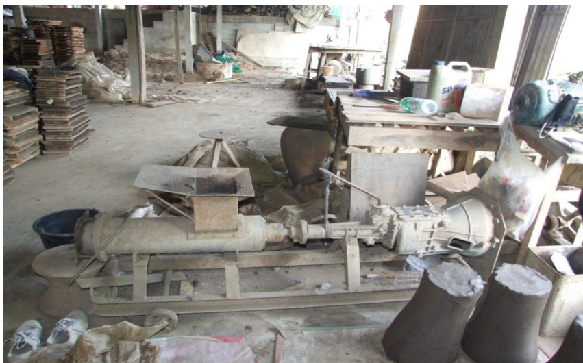
ภาพประกอบ 74 เครื่องนวดดินหรือเครื่องโม่ดินไฟฟ้าเป็นเครื่องมืออุปกรณ์เพิ่มความเหนียวของดิน
