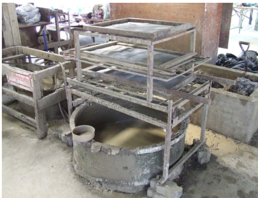
ภาพประกอบ 30 เครื่องกรองน้ำดินเพื่อคัดแยกกรวดทรายและรากไม้โดยใช้ตะแกรงลวด
