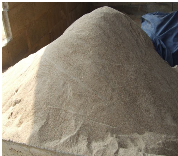
ภาพประกอบ 27 ทราย วัตถุดิบที่ใช้ผสมกับดินเหนียวเพื่อให้เครื่องปั้นดินเผามีความแข็งแรง
