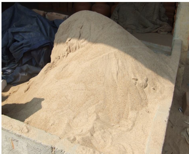
ภาพประกอบ 48 วัสดุดิบ ดินทราย ใช้ผสมกับดินเหนียวเพื่อเพิ่มความแข็งแรงเนื้อภาชนะดินเผา เมื่อถูกความร้อน
