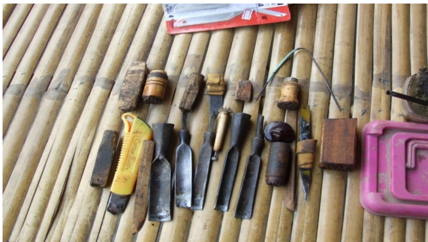
ภาพประกอบ 78 อุปกรณ์เครื่องมือแกะสลักกลวดลายเครื่องปั้นดินเผาประกอบด้วย อุปกรณ์หลายอย่าง ขึ้นอยู่กับงานของช่าง
