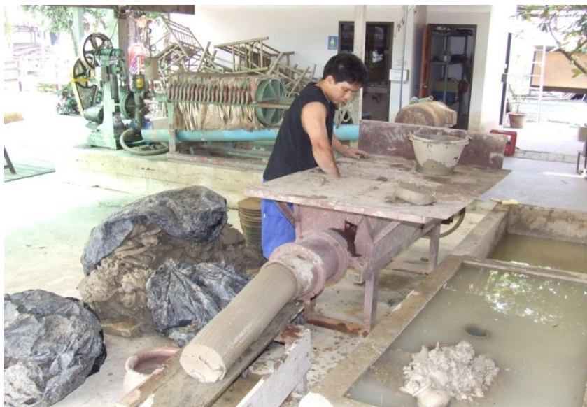
ภาพประกอบ 31 เครื่องนวดดินเพื่อเพิ่มความเหนียวของดิน บ้านเกาะเกร็ด
