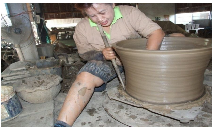
ภาพประกอบ 77 อุปกรณ์เครื่องมือไม้ปลายแหลมสำหรับแทงดินส่วนเกินรอบนอกกันภาชนะเครื่องปั้นดินเผา
