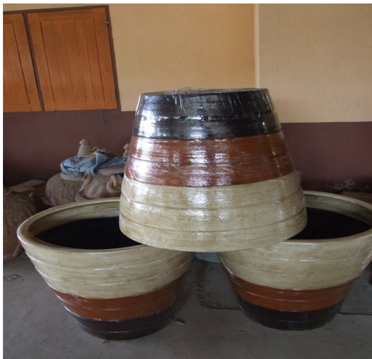
ภาพประกอบ 66 ภาพขณะเครื่องปั้นดินเผาอ่างน้ำหาผิวด้วยน้ำดินชั้นผสมสีตามต้องการ
