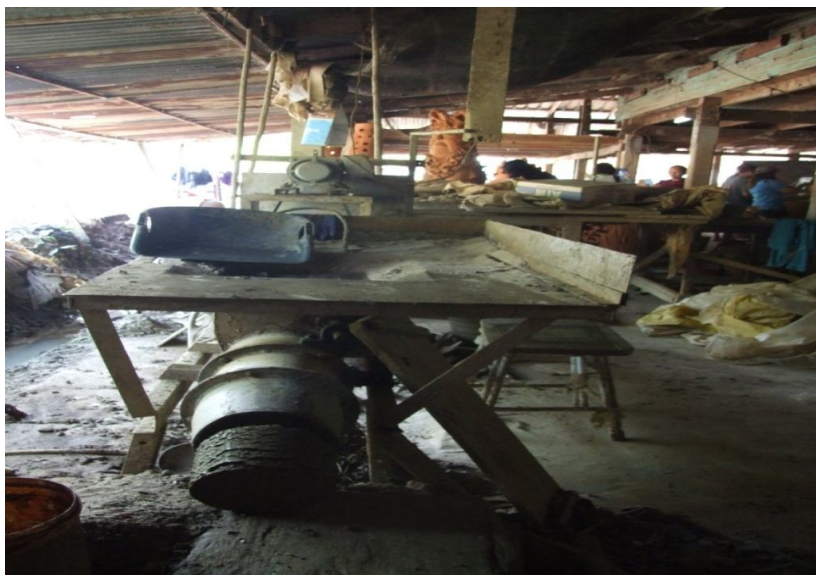
ภาพประกอบ 54 อุปกรณ์เครื่องนวดดิน สำหรับนวดดินเหนียว ดินทรายและน้ำเข้าด้วยกัน เพื่อเพิ่มความเหนียวของดิน
