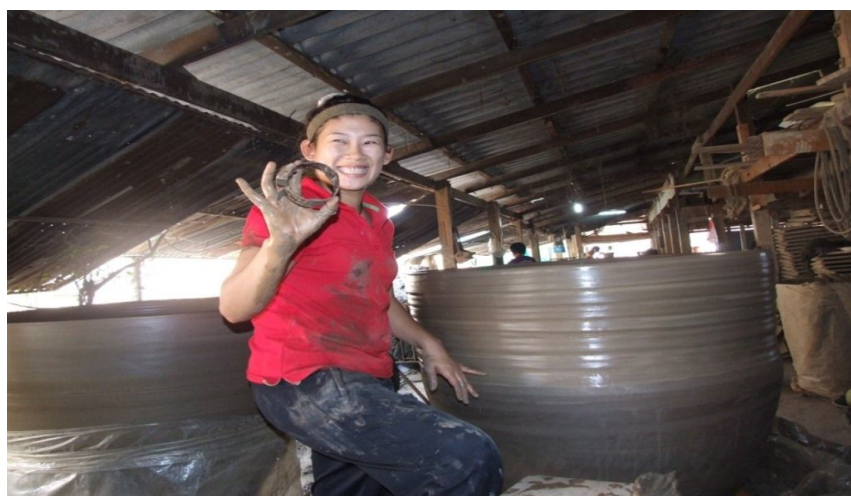
ภาพประกอบ 75 เครื่องมืออุปกรณ์ไม้วงสำหรับตกแต่งผิวภายนอกเครื่องปั้น
