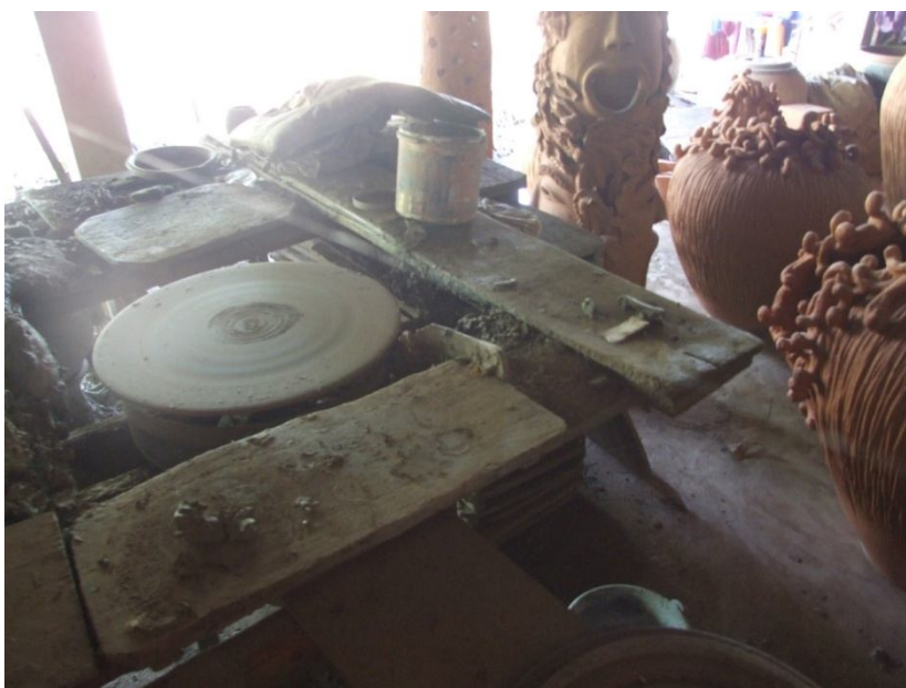
ภาพประกอบ 53 เครื่องมือ อุปกรณ์ แป้นหมุนไฟฟ้า สำหรับปั้นภาชนะเครื่องปั้นดินเผา
