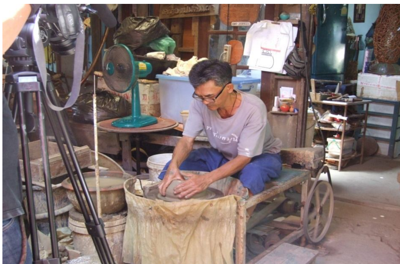
ภาพประกอบ 32 การปั้นพุ่ม หลังจากพุ่มดินลงบนแป้นหมุนใช้นิ้วหัวแม่มือกดก้อนดินเพื่อดึงดินขึ้นเป็นรูปภาชนะตามต้องการ
