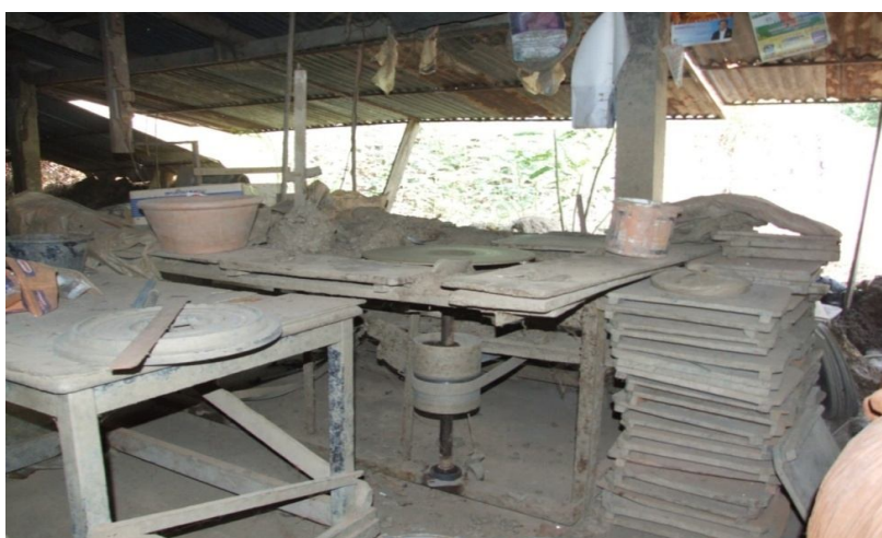
ภาพประกอบ 73 แป้นหมุน เครื่องมืออุปกรณ์การผลิต การปั้น หรือการขึ้นรูปภาชนะเครื่องปั้น
