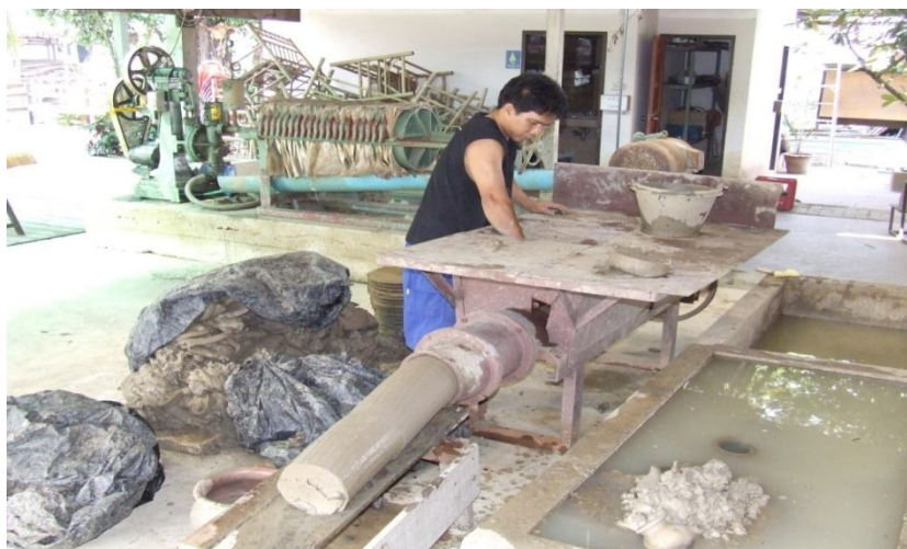
ภาพประกอบ 38 เครื่องนวดดินหรือเครื่องโม่ดิน เครื่องมืออุปกรณ์ในการเพิ่มความเหนียวของดิน
