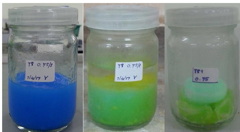
ภาพประกอบภาคผนวก ก-2 การสังเคราะห์ Cu-gel ด้วยกระบวนการโซลเจล
