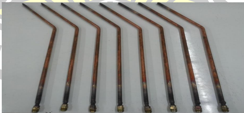
ภาพประกอบ 23 ท่อทองแดงที่เชื่อมปิดด้านปลายแล้ว
