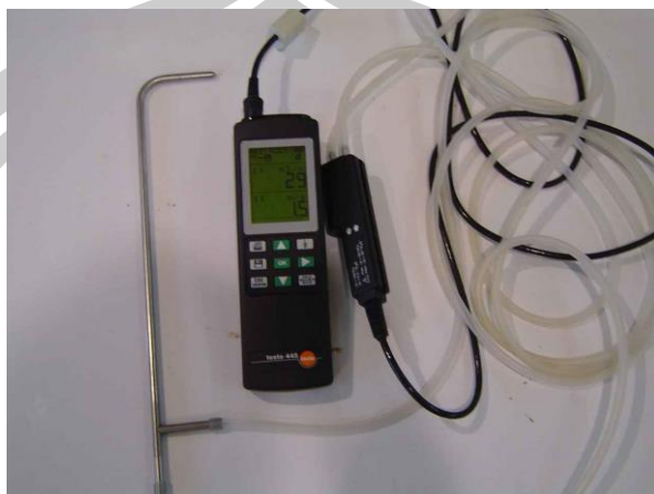
ภาพประกอบ 31 ลักษณะของเครื่องวัดความเร็วลม แบบ Static Pitot Tube
