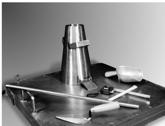
ภาพประกอบ 3.2 ชุดการทดสอบค่าการยุบตัวของคอนกรีต
