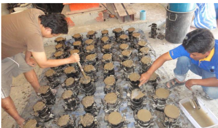
ภาพประกอบ ภาคผนวก จ - 3 การหล่อตัวอย่างคอนกรีต
