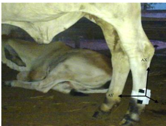
ภาพประกอบ 2.16 ตำแหน่งติดตั้งระบบสมองฝังตัว [9]
