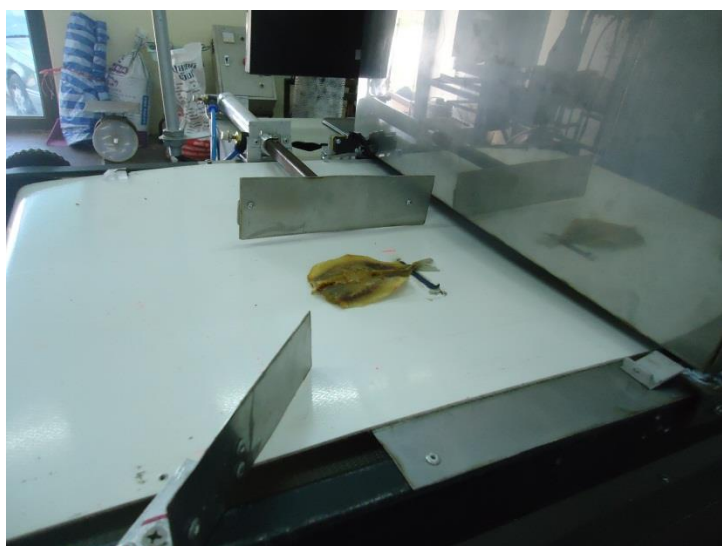
ภาพประกอบ 4.10 ผลทดสอบการตัดแยกปลาข้างเหลืองตากแห้งโดยใช้ระบบกระบอกกลม
