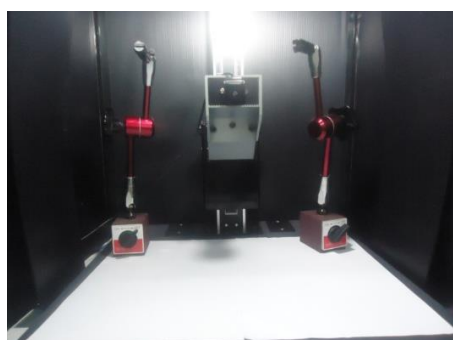
(ก) ตำแหน่งการติดตั้งกล้องดิจิทัลและหลอดไฟส่องสว่าง
