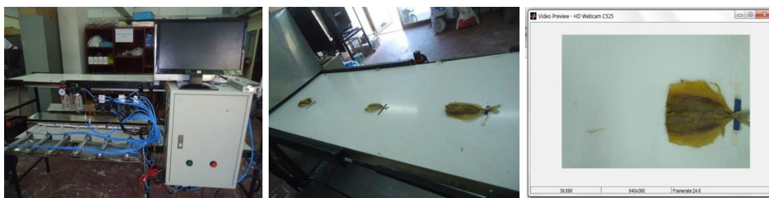
ภาพประกอบ 4.13 แสดงลักษณะในการป้อนเพื่อลำเลียงปลาเพื่อเข้าสู่ชุดประมวลผลภาพดิจิทัลและการจับภาพด้วย
