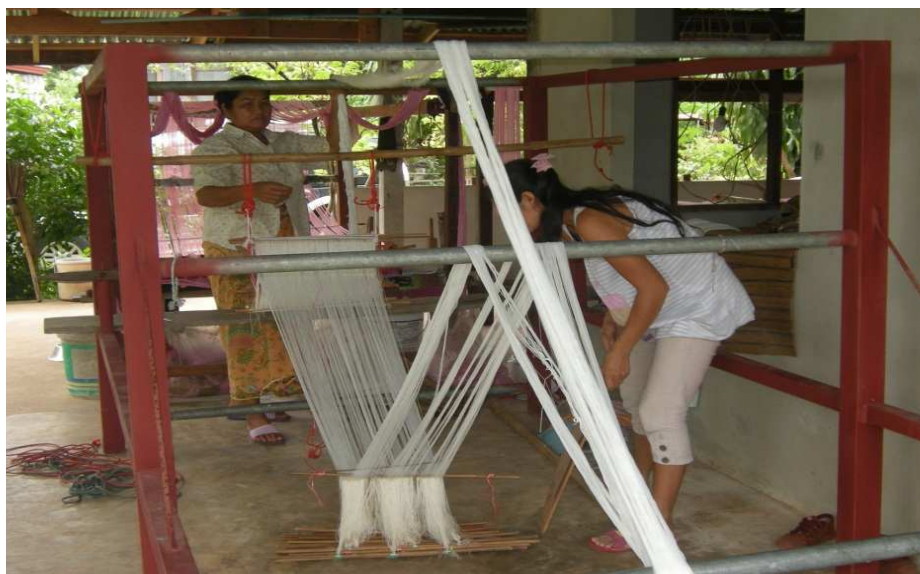
ภาพประกอบ 22 การติดตั้งเครื่องทูกเข้ากับกี่
