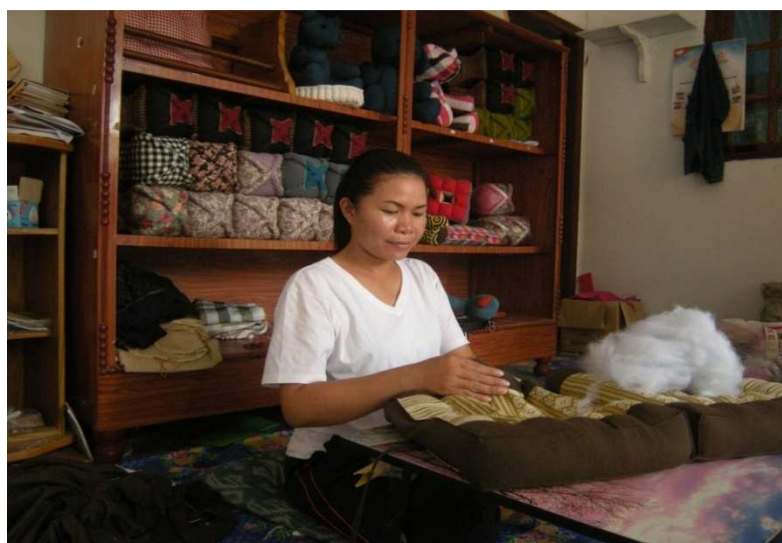
ภาพประกอบ 70 การยัดนุ่นหรือใยสังเคราะห์เบาะนั่งผ้าซิดปักมือ
