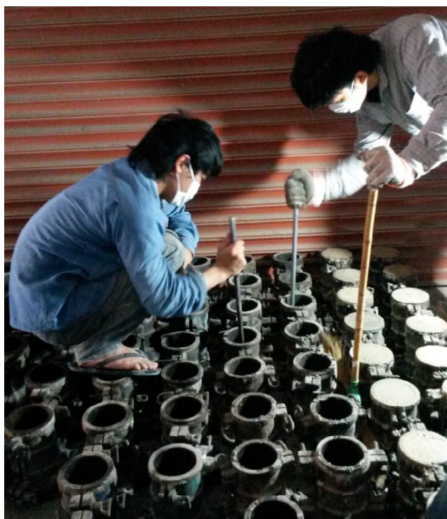
ภาพประกอบ จ.5 การบรรจุคอนกรีตลงในแบบหล่อ
