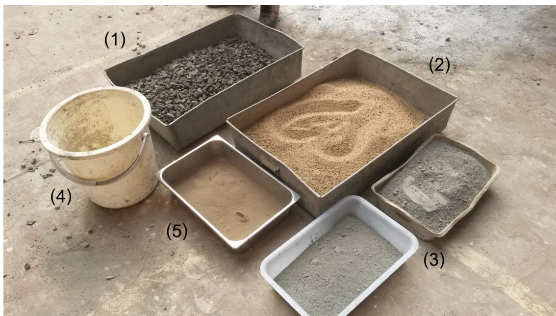
ภาพประกอบ จ.1 ส่วนประกอบของคอนกรีตตัวอย่าง (1) หินขนาด 3/4 นิ้ว (2) ทราย (3) ซีเมนต์พอร์ตแลนด์ประเภทที่ 1 (4) น้ำประปา (5) etailบดละเอียด
