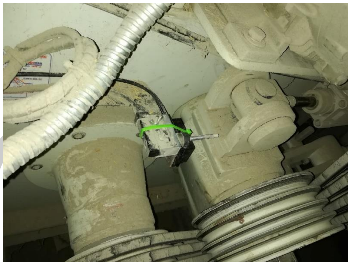
ภาพประกอบ 35 ตำแหน่งการติดตั้งเซ็นเซอร์วัดระยะของก้านดันลูกยาง
