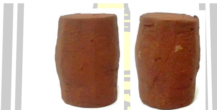
ภาพประกอบที่ 4.15 ผลการทดสอบแรงอัดสามแกน CD-Test (ดินทราย:ดินเม็ดละเอียด เท่ากับ 0:100)
