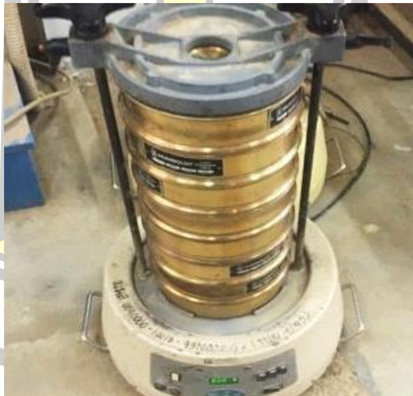
ภาพประกอบที่ 4.6 การร่อนผ่านตะแกรงเพื่อหาการกระจายขนาด
