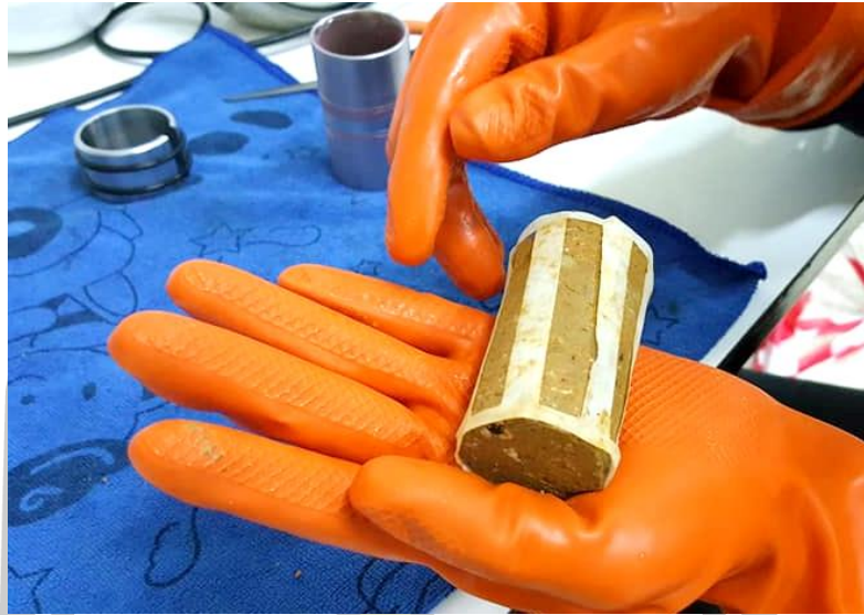
ภาพประกอบที่ 4.9 การเตรียมตัวอย่างเพื่อทดสอบแรงอัดสามแกน
