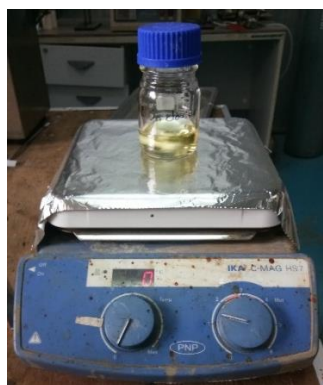
เตรียมสารละลายพอลิเมอร์ กับ สารตั้งต้น \text{SnCl}_2 \cdot 2\text{H}_2\text{O}
