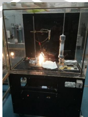
นำสารละลายบรรจุในเข็มฉีดยาขนาด 10 ml และเข้าสู่กระบวนการอิเล็กโทรสปินนิง
