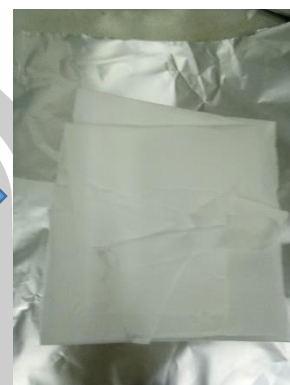
เก็บเส้นใยที่ปั่นได้ จากกระบวนการอิเล็กโทรสปินนิง
