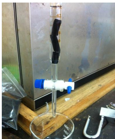
ภาพประกอบ ค.20 การหาความหนาแน่นของถ่านอัดเม็ดด้วยการจุ่ม n-heptane
