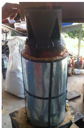
ภาพประกอบ ค.22 เตาผลิตก๊าซชีววมวลแบบอากาศไหลขึ้นร่วมกับเครื่องผลิตไฟฟ้าแบบเทอร์โมอิเล็กทริก
