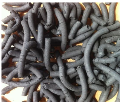
ภาพประกอบ ค.17 ถ่านไม้ยูคาลิปตัสอัดเม็ดโดยใช้อัตราส่วนตัวประสานมากเกินไป (มากกว่า30%)
