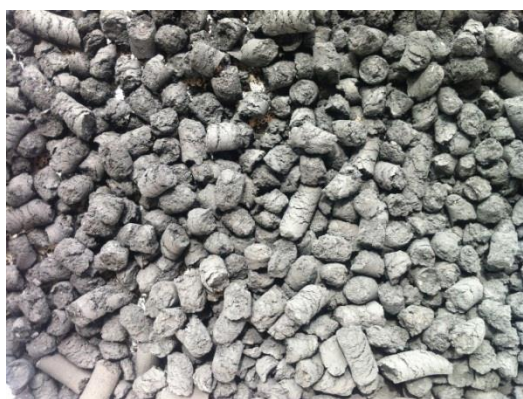
ภาพประกอบ ค.16 ถ่านไม้ยูคาลิปตัสอัดเม็ดโดยไม่ใช้ตัวประสาน
