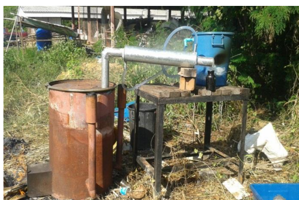
ภาพประกอบ ค.6 การติดตั้งชุดควบแน่นน้ำส้มควันไม้เข้ากับเตาเผา
