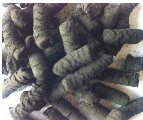
ภาพประกอบ ค.18 ถ่านไม้ยูคาลิปตัสอัดเม็ดที่มีลักษณะไม่ดี ผิวถ่านแตกร้าว
