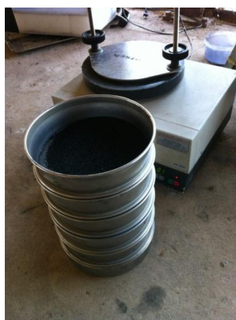
ภาพประกอบ ค.14 เครื่องร่อนแยกขนาด (Vibratory sieve shaker) ยี่ห้อ Retsch รุ่น AS 200
