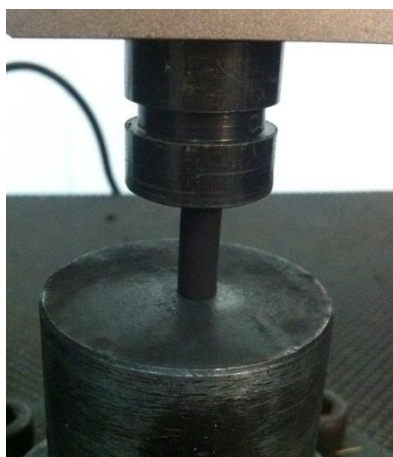
ภาพประกอบ ค.21 การทดสอบสมบัติเชิงกลของถ่านอัดเม็ด
