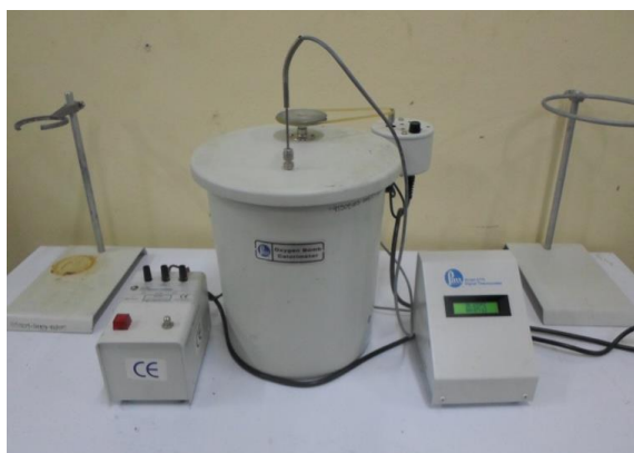
ภาพประกอบ ค.5 บอมป์แคลอรีมิเตอร์ 1341 Calorimeter พร้อมมอเตอร์สายพาน ลูกบอมป์ และ ถังน้ำ
