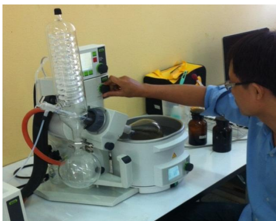
ภาพประกอบ ค.12 เครื่องกลั่นสารระเหยแบบหมุน Rotary evaporator รุ่น BUCHI R215100-240
