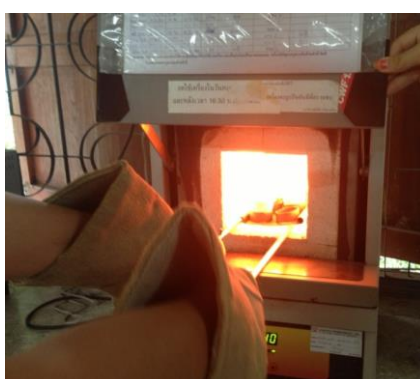
ภาพประกอบ ค.3 เตาเผาความร้อนสูง (Muffle furnace) ยี่ห้อ Carbolite รุ่น CFW 1200
