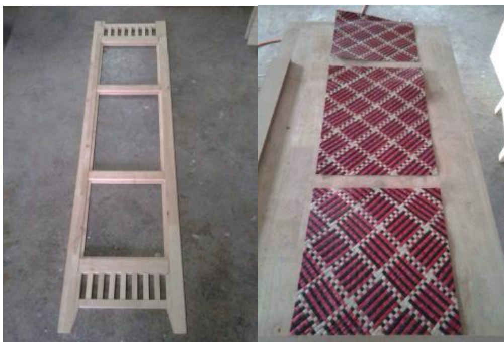
ภาพประกอบ 68 ขั้นตอนการทำฉากกั้นห้อง
