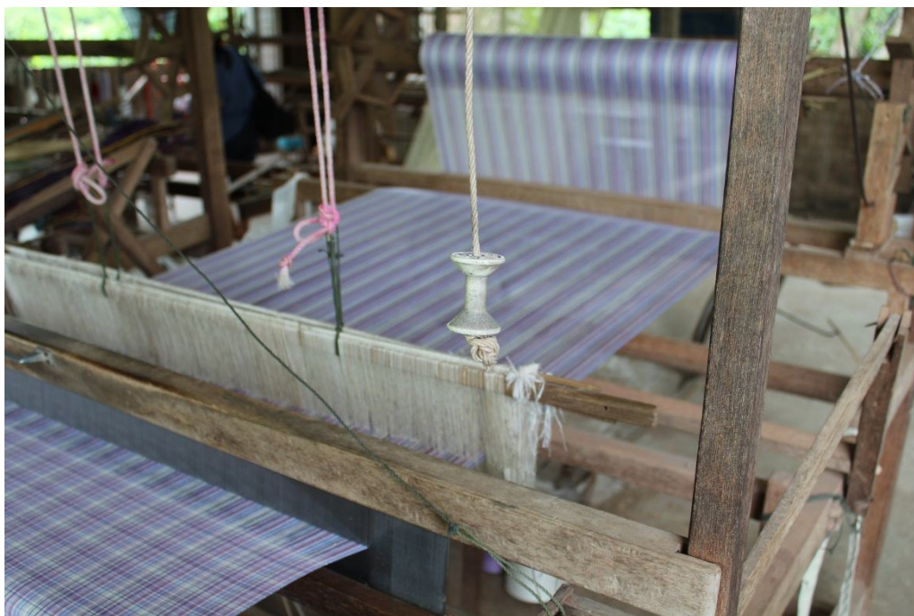
ภาพประกอบ 29 เขาฮุกหรือตะกอ (อุปกรณ์ที่ใช้แยกเส้นยืน)
