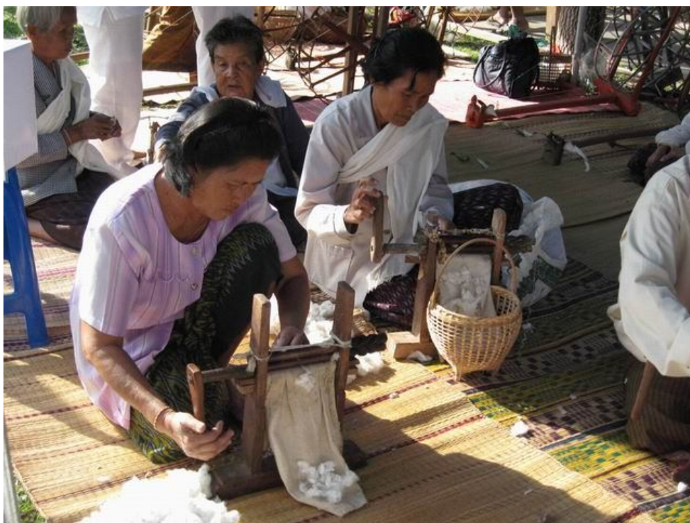
ภาพประกอบ 39 อี้วฝ้าย (อี๊ดฝ้าย) สำหรับคัดแยกเมล็ดฝ้ายออกจากปุยฝ้าย
