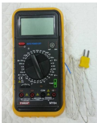
ภาพประกอบ 3.3 ดิจิตอลมัลติมิเตอร์รุ่น YUGO MY64 ที่ใช้ในการทดลอง
