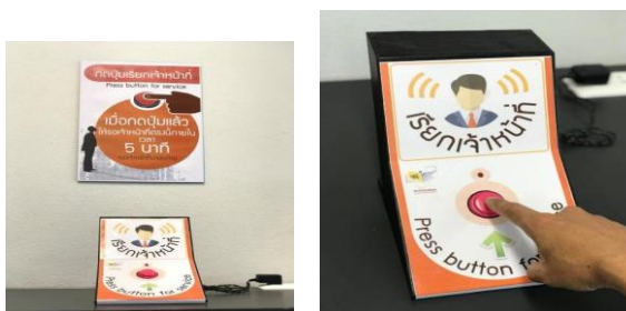
รูปที่ 3 ต้นแบบเครื่องกดปุ่มเพื่อเรียกหาเจ้าหน้าที่ผ่านไลน์
