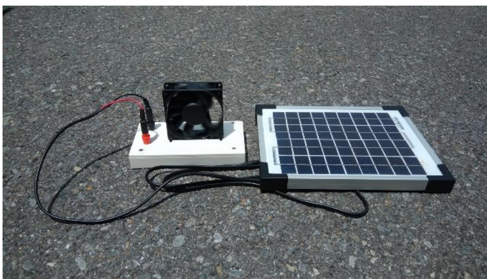
ภาพที่ 5 ฐานการต่อพัดลมกับแผงเซลล์แสงอาทิตย์
