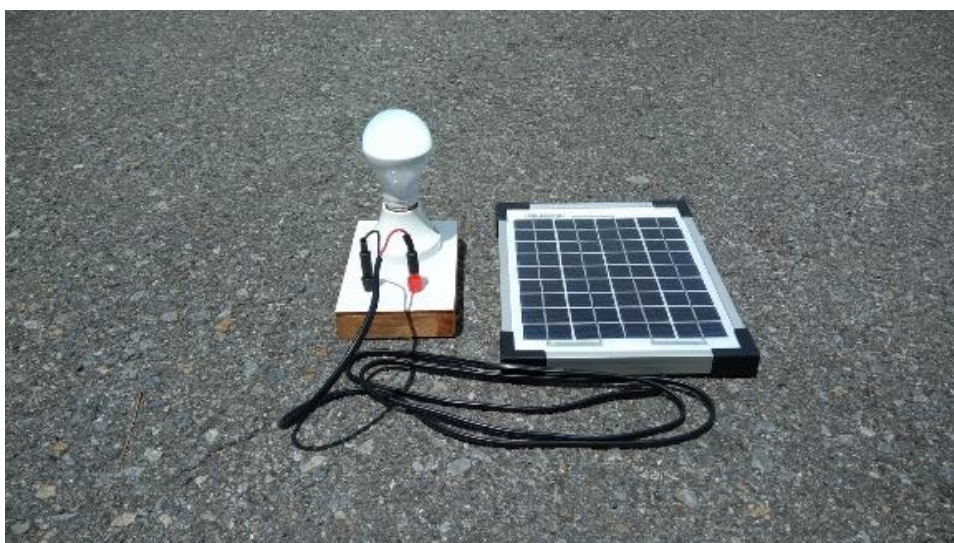
ภาพที่ 4 ฐานการต่อหลอดไฟกับแผงเซลล์แสงอาทิตย์
