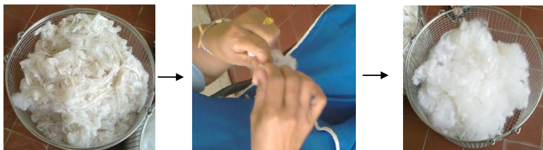
ภาพประกอบ 3.3 ขั้นตอนการยีสางรังไหม
