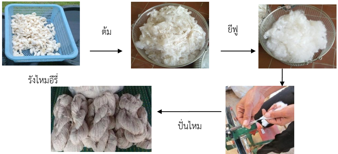
ภาพประกอบ 2.5 การปั่นเส้นอีรี่แบบแห้ง
