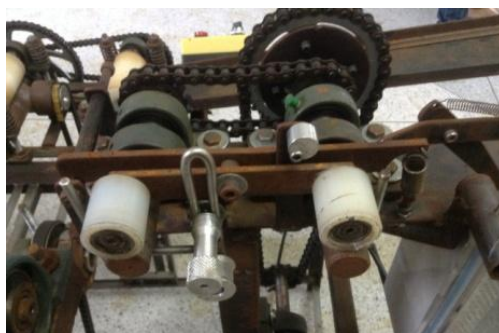
ภาพประกอบ 4.12 ลูกรีดป้อนใยไหม
