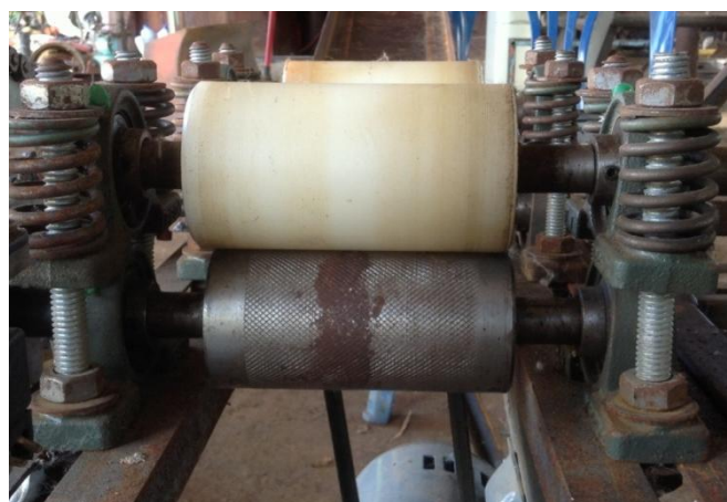
ภาพประกอบ 4.8 ลูกรีดป้อนใยไหม
