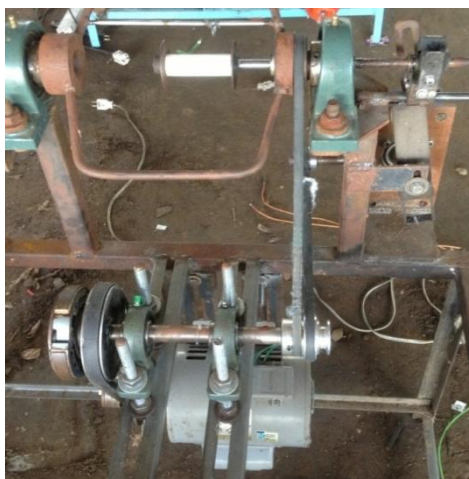
ภาพประกอบ 4.13 ระบบส่งกำลังชุดวงแหวนตีเกลียวเส้นไหม
