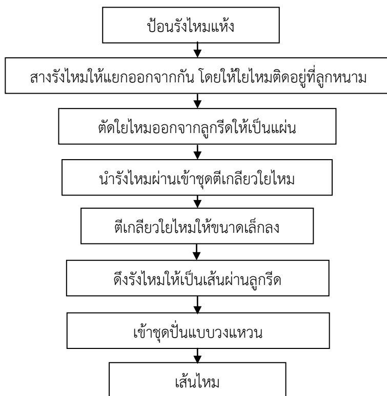
ภาพประกอบ 3.19 ไตอะแกรมขั้นตอนการทำงานของเครื่องสาวรังไหมและเครื่องตีเกลียวเส้นไหม
