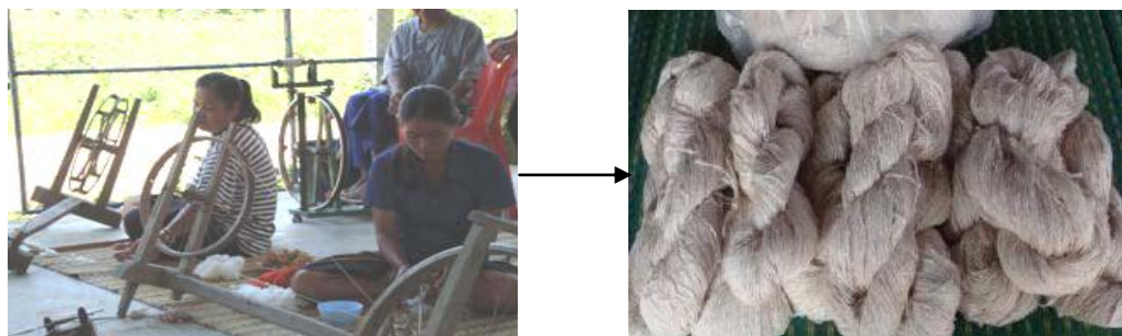
ภาพประกอบ 3.4 การปั่นเส้นไหมด้วยเครื่องปั่นฝ้าย
