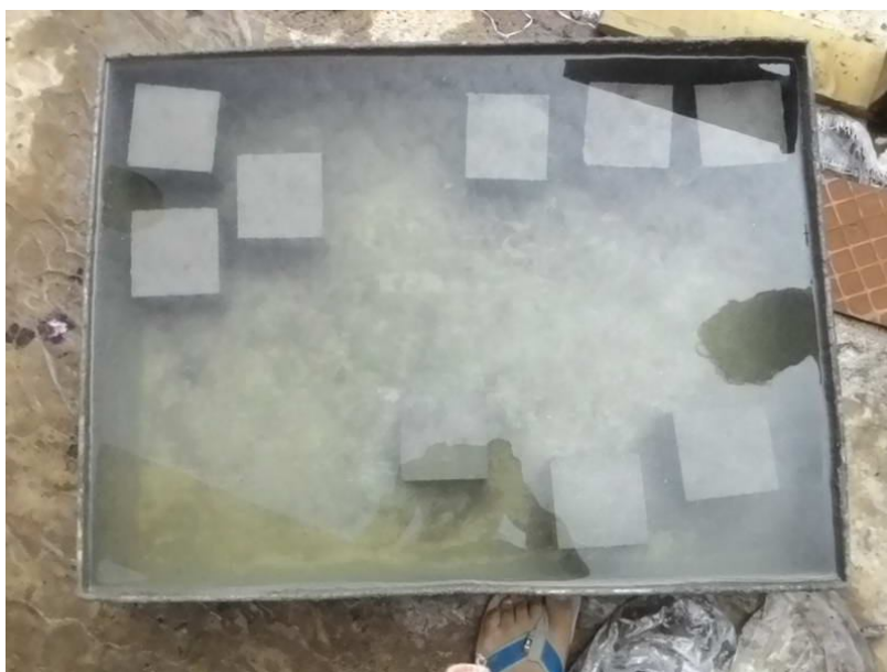
ภาพประกอบ 3.9 การเก็บตัวอย่างคอนกรีตบล็อกเพื่อนำไปทดสอบหาค่ากำลังอัดประลัย
