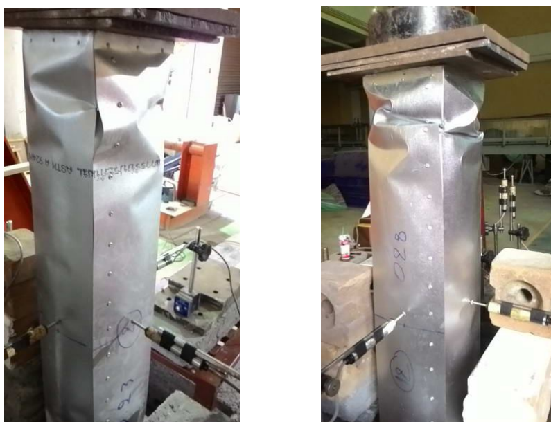
ภาพประกอบ 4.14 การวิบัติของเสาบริเวณปลายเสาด้านบน
