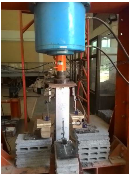
ภาพประกอบ 3.10 การทดสอบน้ำหนักกดประลัย
