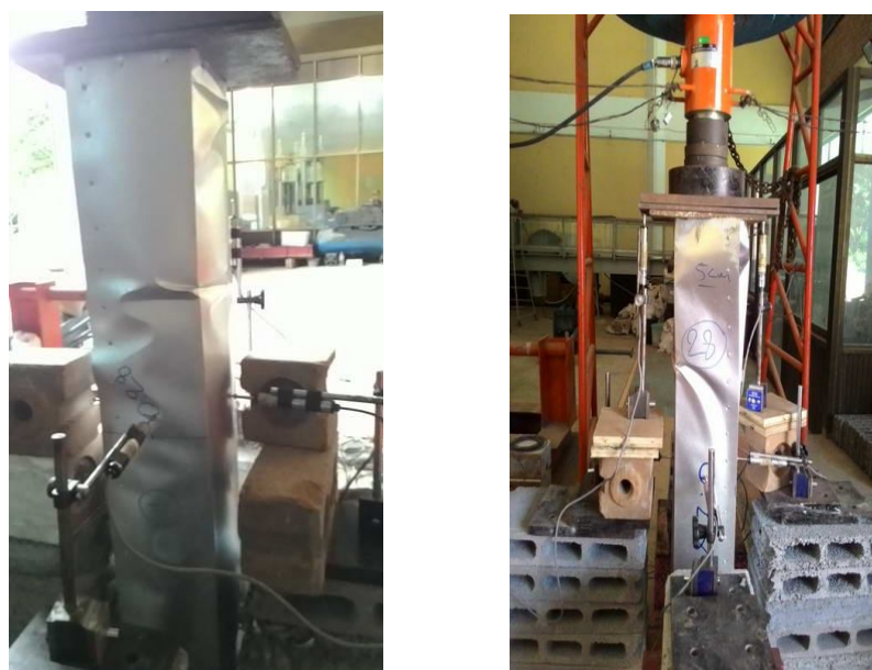
ภาพประกอบ 4.15 การวิบัติของเสาบริเวณกึ่งกลางเสา
