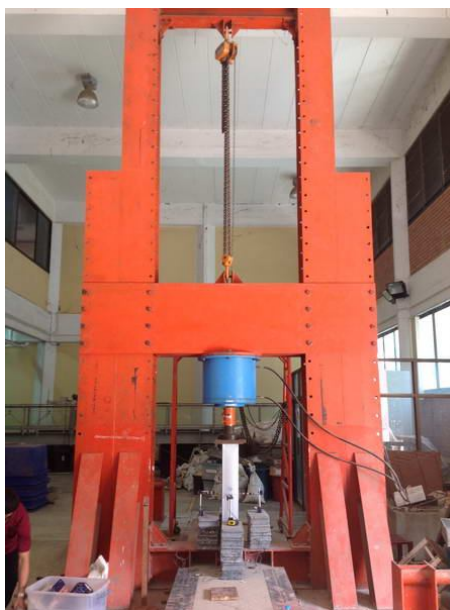
ภาพประกอบ 3.1 เครื่องทดสอบการรับน้ำหนักของเสา
