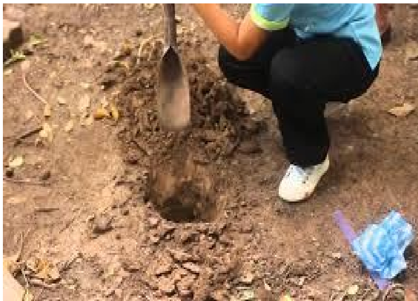
ภาพประกอบ 31 การเก็บตัวอย่างดินเพื่อนำไปวิเคราะห์คุณภาพของดิน
