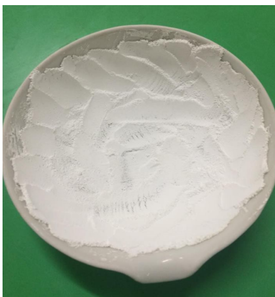
ภาพประกอบ 4.3 ลักษณะแคลเซียมออกไซด์ที่ได้หลังจากการแคลไซน์
