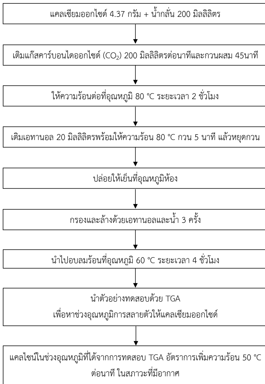
ภาพประกอบ 3.3 แผนผังการสังเคราะห์แคลเซียมออกไซด์ด้วยวิธีทำให้เกิดเป็นโครงสร้างแบบลำดับขั้น
