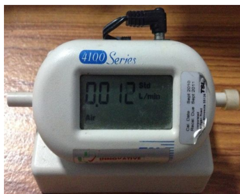
ภาพประกอบ 7 เครื่องวัดอัตราการไหลของอากาศ
