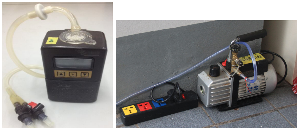
ภาพประกอบ 6 ปัมป์เก็บตัวอย่างอากาศชนิดพกพา และ ปัมป์เก็บตัวอย่างบริเวณสถานี
