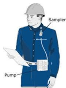
ภาพประกอบ 2 การเก็บตัวอย่างสารเคมีในอากาศแบบติดตั้งที่ตัวบุคคล
