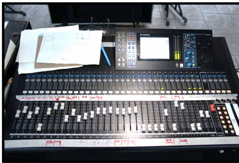
ภาพประกอบ 12 มิกเซอร์ยามาฮ่ารุ่นแอลเอส 9 -32
