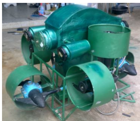
ภาพประกอบ 3.12 แสดงโครงสร้างการออกแบบหุ่นยนต์ใต้น้ำอัตโนมัติ
