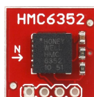
ภาพประกอบ 3.6 เข็มทิศอิเล็กทรอนิกส์ (Compass module รุ่น HMC6352)
