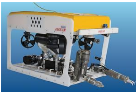
ภาพประกอบ 2.5 SAAB Seaeeye ROVs ใช้สำหรับการซ่อมอุปกรณ์ใต้น้ำ พัฒนาโดย Middle East to New Zealand
