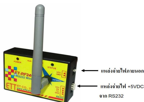
ภาพประกอบ 3.8 บอร์ดการสื่อสารไร้สาย RS232 to RF-wireless (RF2.4GHz)
