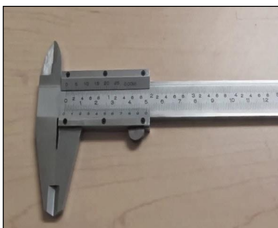
ภาพประกอบ 3.6 เครื่องมือวัด เวอร์เนียล (Vernier Caliper)
