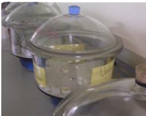
ภาพประกอบ 3.17 การนำปุ๋ยอินทรีย์ชีวภาพเม็ดใส่ไว้ในโถดูความชื้น
