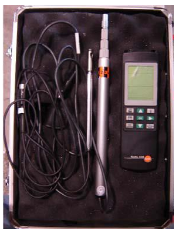
ภาพประกอบ 3.7 เครื่องมือที่ใช้ความเร็วลมของอากาศ
