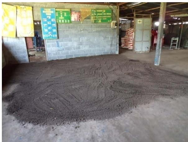
ภาพประกอบ 1.1 การอบแห้งปุ๋ยอินทรีย์ชีวภาพเม็ดด้วยการตากบนพื้นคอนกรีตภายในอาคารของโรงงาน
