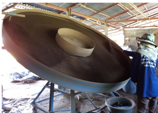
ภาพประกอบ 3.13 งานปั้นเม็ดปุ๋ยอินทรีย์ชีวภาพ
