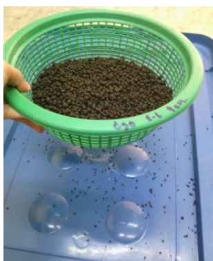
ภาพประกอบ 3.14 การใช้ตะแกรงร่อนเอาเม็ดปุ๋ยอินทรีย์ชีวภาพเม็ดขนาดเล็กออก
