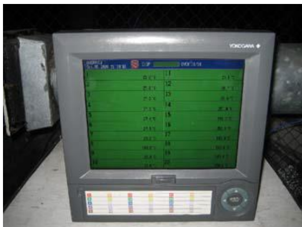
ภาพประกอบ 3.3 เครื่องมือที่ใช้วัดและบันทึกอุณหภูมิ
