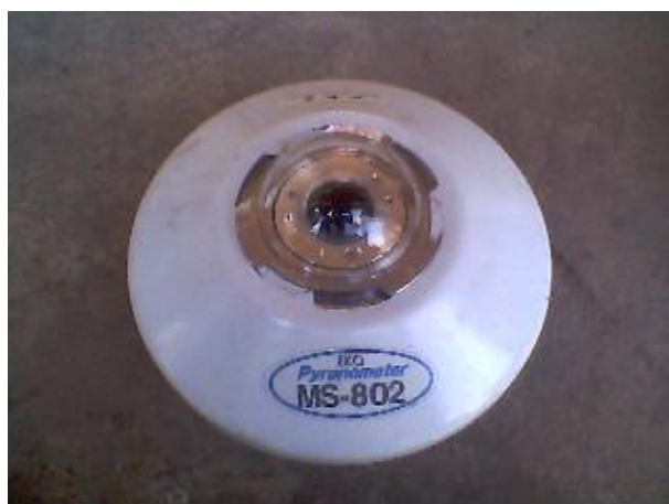
ภาพประกอบ 3.4 เครื่องมือวัดค่าพลังงานแสงอาทิตย์ (Pyranometer)
