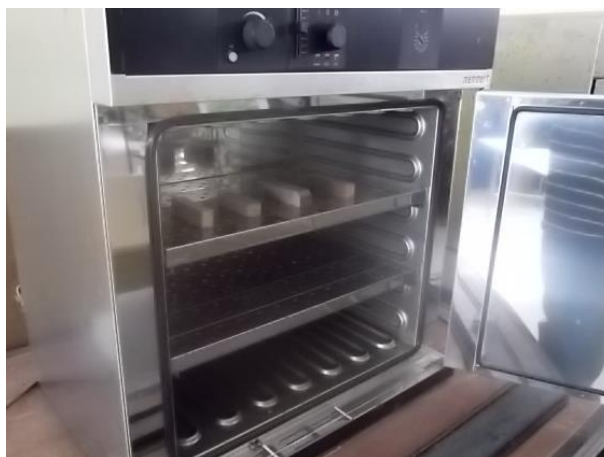
ภาพประกอบ 3.16 ตู้อบลมร้อนที่ใช้หาความชื้นปุ๋ยอินทรีย์ชีวภาพเม็ด
