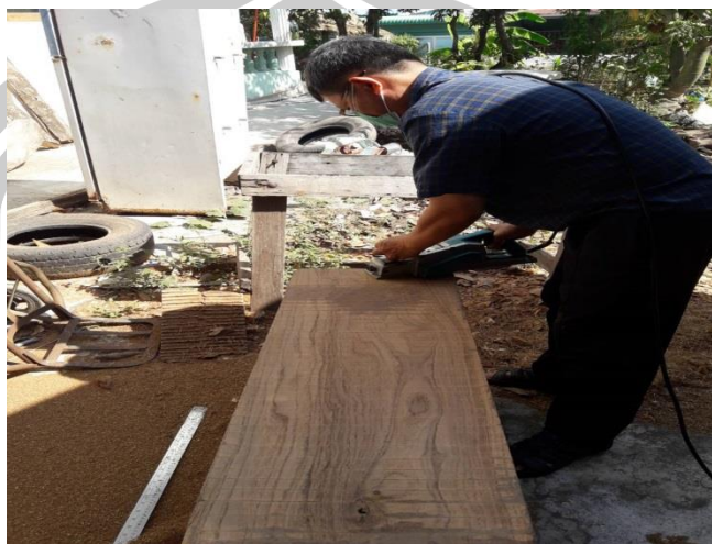
ภาพประกอบ 39 การใช้กบไฟฟ้าใส่หน้าไม้ให้เรียบก่อนจะวางแบบชอนวง
