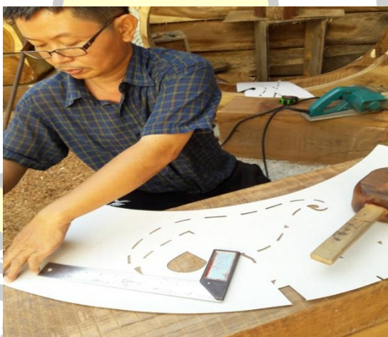
ภาพประกอบ 54 การทาบแบบกระดาษแข็งแล้วเขียนด้วยปากกาเคมี เพื่อตัดไม้ให้ได้ตามแบบ
