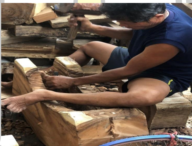
ภาพประกอบ 56 ใช้สิ่วหน้าใหญ่สกัดเนื้อไม้ส่วนเกินออก
