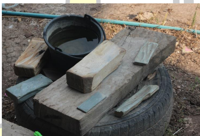
ภาพประกอบ 44 หินสำหรับรับส่วให้คมอยู่เสมอ
