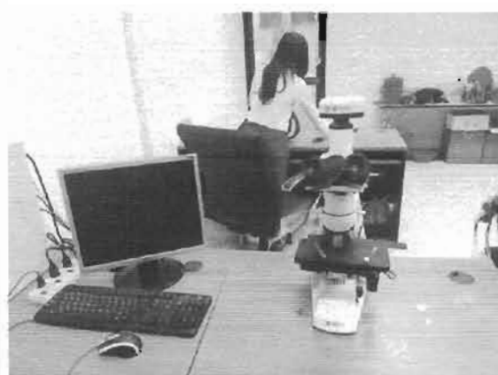
ภาพประกอบ 22 การดูโครงสร้างของผลึกด้วยกล้องจุลทรรศน์ Polarized Microscope
