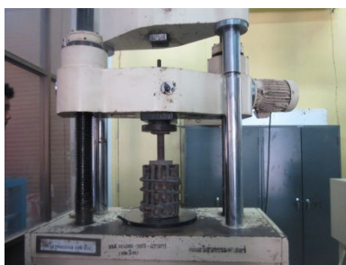
ภาพประกอบ 12 เครื่องทดสอบแรงกด (UTM)
