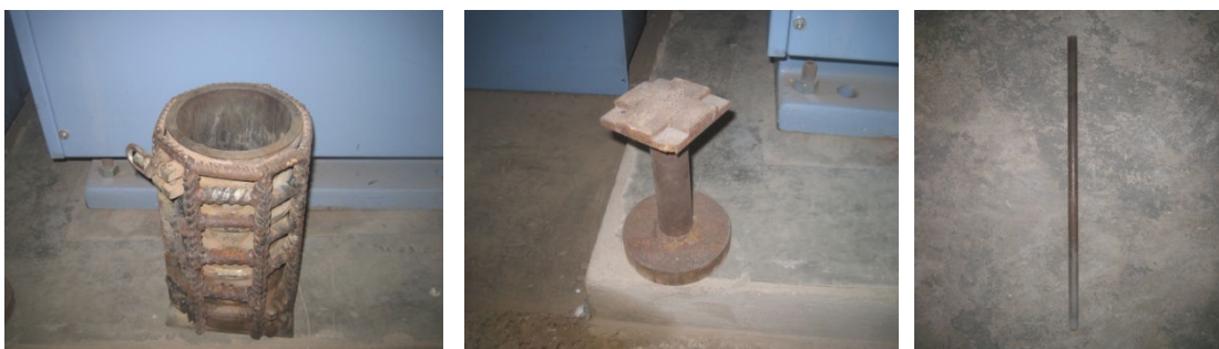
ภาพประกอบ 11 แบบหล่อพร้อมแกนเหล็กกวดและเหล็กกระทุ้ง
