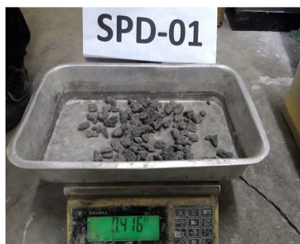
ภาพประกอบ 39 นำหินขึ้นจากการแฉ่
