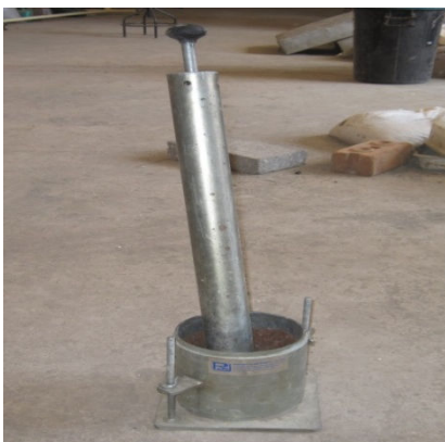
ภาพประกอบ 2 แบบหล่อที่ใช้ในการย่อย
