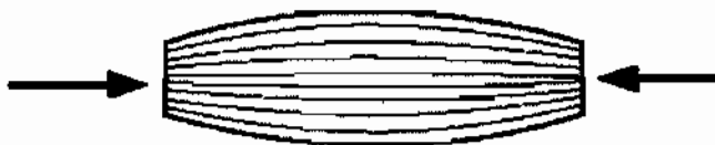
ภาพประกอบ 8 แสดงลักษณะคอมโพสิตที่ได้รับแรงกดอัด ที่มา: (สุภาสิณี ลิ้มปานภาพ. 2540: 53)
