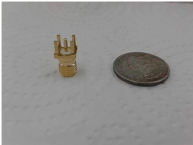
ภาพประกอบ 6 ลักษณะโพรบแกนร่วมแบบปลายเปิด
