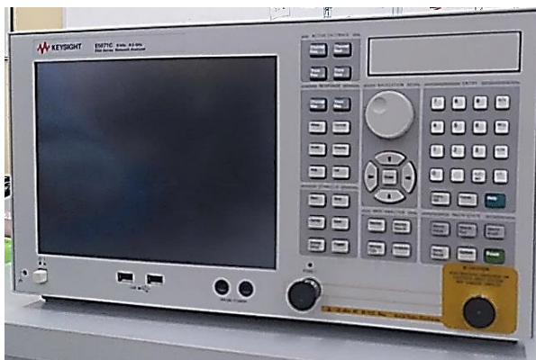
ภาพประกอบ 5 เครื่องวิเคราะห์ข่ายงานสื่อสาร (Vector Network Analyzer : VNA)
