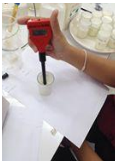
ภาพประกอบ 18 การวัดความเป็นกรด-ต่าง (pH) ทุกชั่วโมงขณะบ่มโยเกิร์ต
