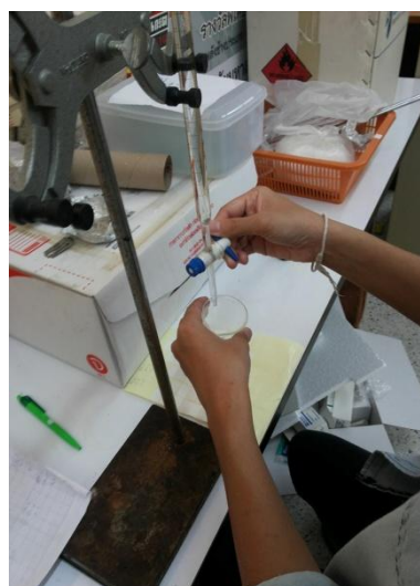
ภาพประกอบ 26 โทเตรทกับโซเดียม ไฮดรอกไซด์
