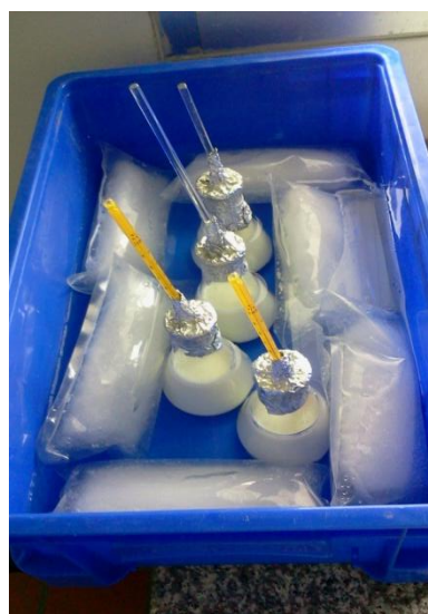
ภาพประกอบ 13 การลดอุณหภูมิด้วย น้ำเย็น
