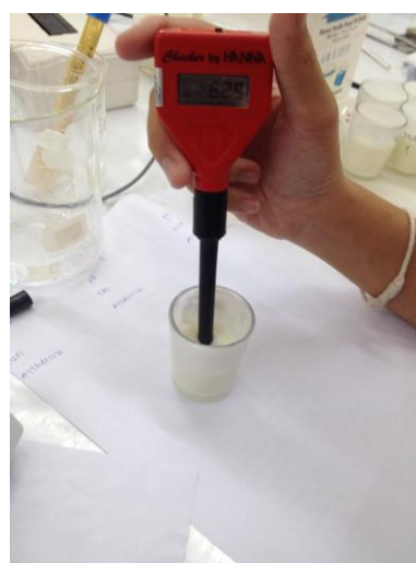
ภาพประกอบ 15 การวัด pH ก่อนเข้าสู่บ่มโยเกิร์ต
