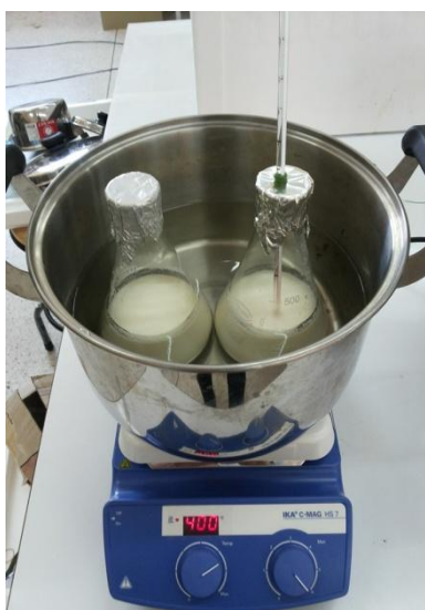
ภาพประกอบ 12 การต้มหางนม โดยการควบคุม อุณหภูมิ
