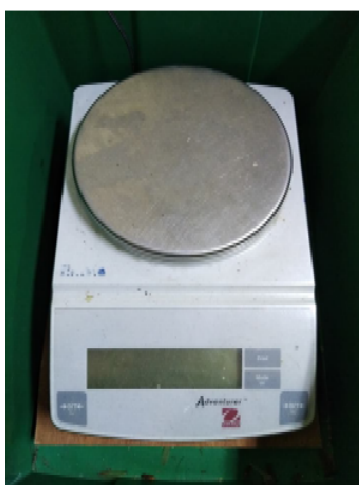
ภาพประกอบ 20 เครื่องชั่งน้ำหนักแบบดิจิทัล
