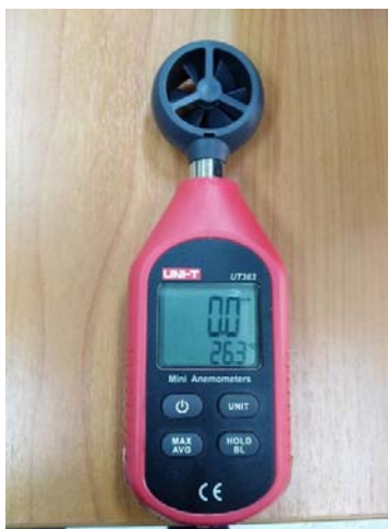
ภาพประกอบ 19 เครื่องวัดความเร็วลม UNI-T UT363
