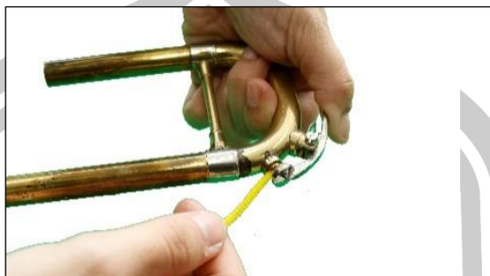
รูปภาพที่ 149 การทำความสะอาดรูที่ปล่อยน้ำลาย ที่มา : พินัย ปริชากรณ (2562)
