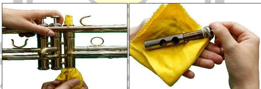
รูปภาพที่ 150 การทำความสะอาดเสื่อสูบ ที่มา : พินัย ปริชากรณ (2562)
