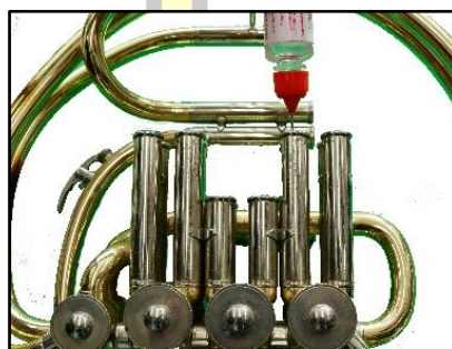
รูปภาพที่ 153 การใส่น้ำมันสำหรับลูกสูบหมุน
