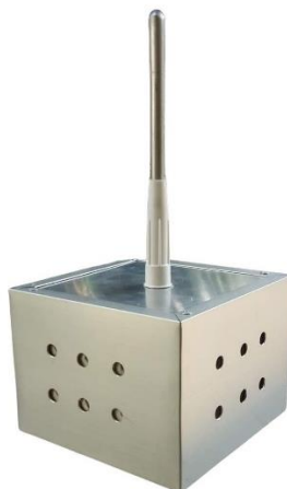
ภาพประกอบ 40 ภายนอกอุปกรณ์เทอร์โมอิเล็กทริกไร้สาย-ไร้พลังงาน
