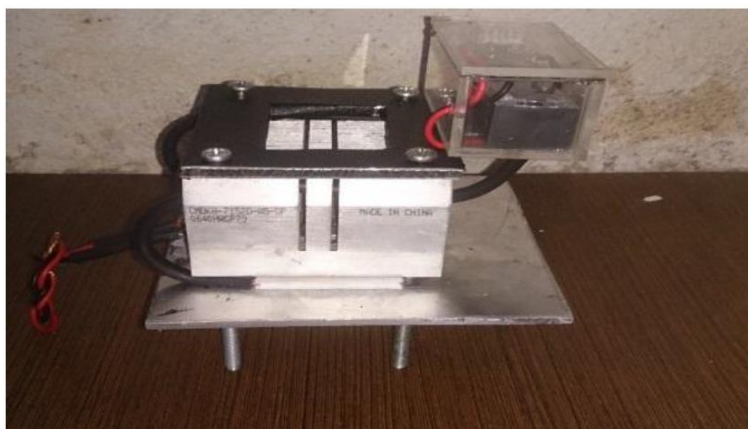
ภาพประกอบ 31 อุปกรณ์เทอร์โมอิเล็กทริกที่ทำการทดลอง
