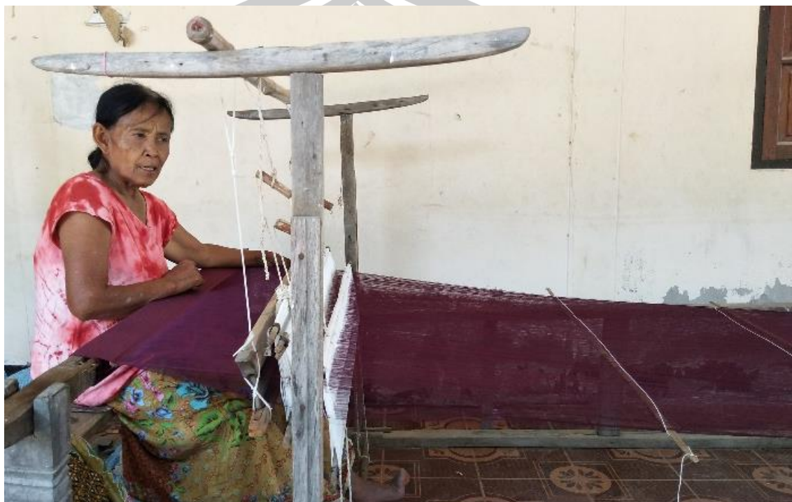
ภาพประกอบ 70 ช่างทอบ้านสวด อำเภอเขวาสินรินทร์ กำลังใช้กี่ทอมือโบราณในการทอผ้า ที่มา : นายโยธิน บุญยงค์; 2562 : ผู้บันทึกภาพ
