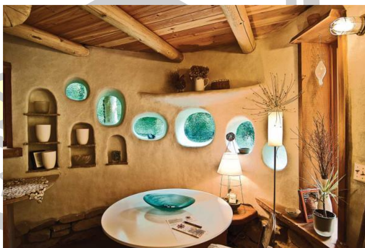
ภาพประกอบ 20 การออกแบบผนังบ้านดินให้มีความโค้งเพื่อการรับน้ำหนักได้มากขึ้นและสร้างความรู้สึกอบอุ่น ปลอดภัยแก่ผู้อยู่อาศัย
