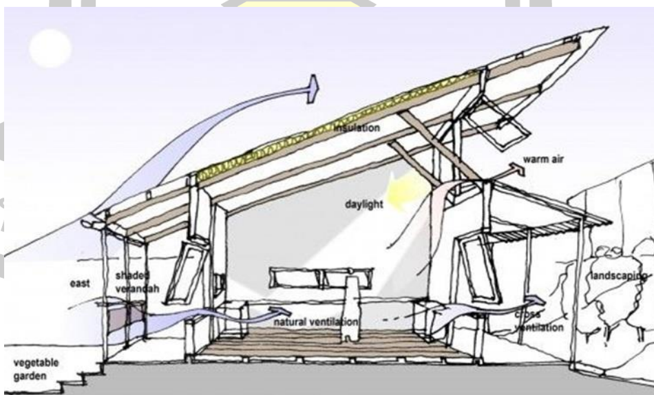
ภาพประกอบ 76 ภาพการออกแบบหลังคาที่ช่วยในการระบายอากาศที่ดี
