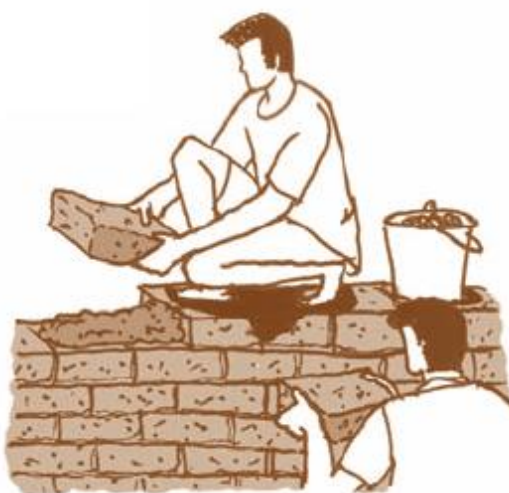
ภาพประกอบ 22 เทคนิคการก่อด้วยอิฐดินดิบ (Adobe) ที่มา: http://www.baandin.com/:2551(Online)
