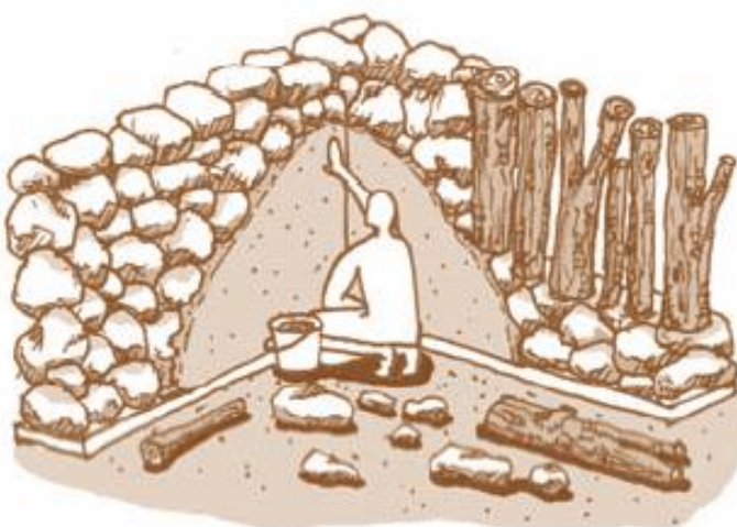
ภาพประกอบ 25 การใช้เศษไม้หรือหิน (Cordwood or Stone) เป็นโครงสร้าง
