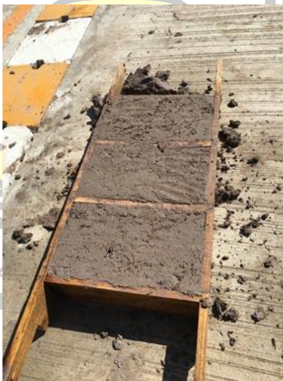
ภาพประกอบ 108 ภาพการนำดินเทลงแม่พิมพ์ แล้วปาดให้เสมอบน
