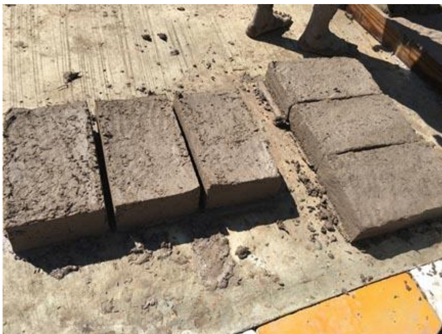
ภาพประกอบ 109 ภาพการนำดินออกจากแม่พิมพ์และตากแห้ง
