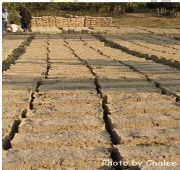
ภาพประกอบ 27 อิฐดินดิบที่นำมาตากแดด ที่มา: http://www.baandin.com/:2551 (Online)
