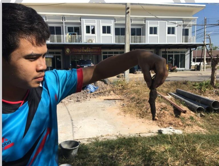
ภาพประกอบ 68 ภาพการทดสอบดินโดยการปั้น
