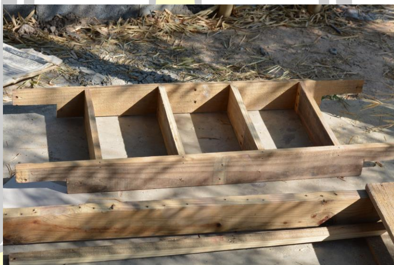
ภาพประกอบ 102 ภาพไม้แบบทำบล็อกอิฐดินดิบ
