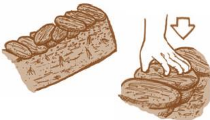
ภาพประกอบ 23 เทคนิคดินปั้น (Cob) ที่มา: http://www.baandin.com/:2551(Online)
