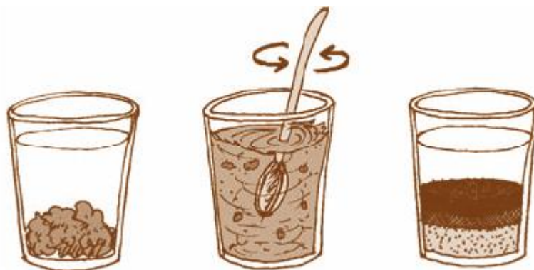
ภาพประกอบ 17 การทดสอบเพื่อดูสัดส่วนของทราย ดินตะกอน และดินเหนียว
